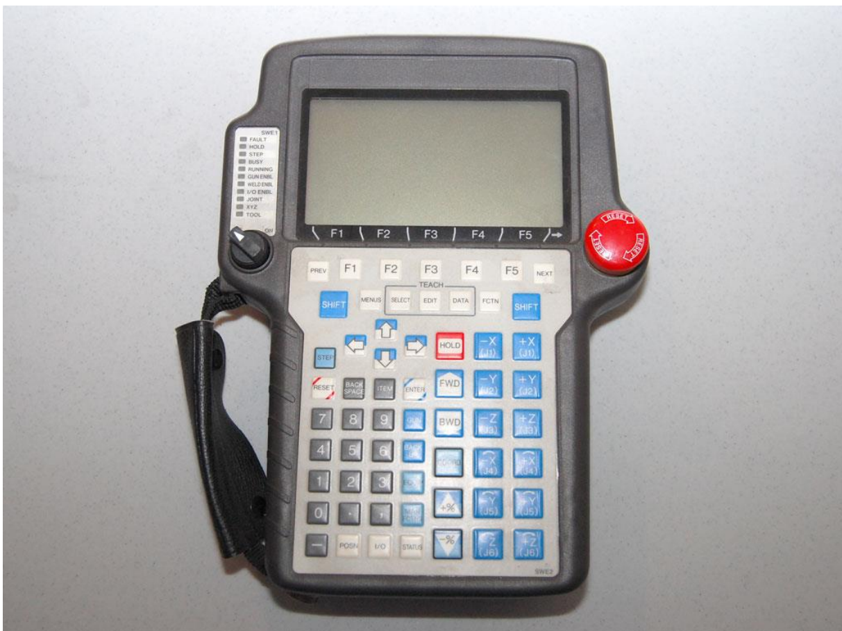
Slika 16. Teach pendant kod ON-LINE programiranja
