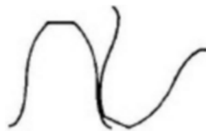
Slika 8. Zahvat cikloidnih bokova
