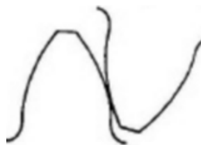
Slika 9. Zahvat evolventnih bokova
