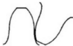
Slika 8. Zahvat cikloidnih bokova
