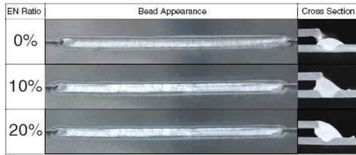
**Slika 10.** Utjecaj balansa negativnog polariteta na oblik zavara i geometriju spoja
