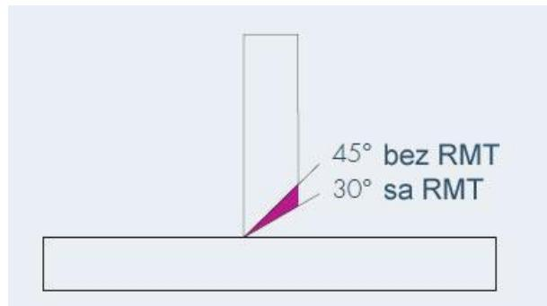
**Slika 15.** Priprema kutnog spoja kod RMT postupka zavarivanja
