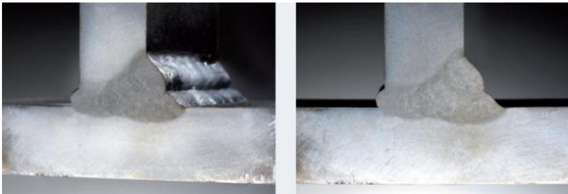
**Slika 14.** Prikaz kutnog spoja izvedenog RMT postupkom d=20mm
