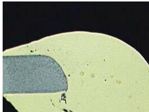
**Slika 11.** Makroizbrusak tvrdo lemljenog spoja žicom ER-CuSi A na pocinčanom čeliku, udio negativnog polariteta EN=70%
