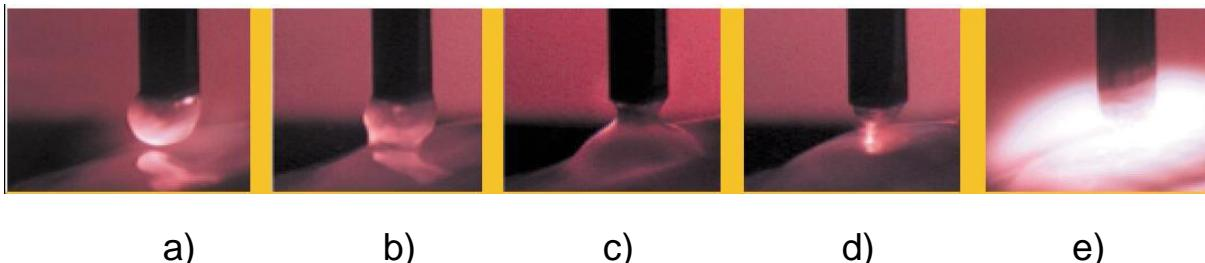
**Slika 3.** Način odvajanja kapljice pri STT zavarivanju
