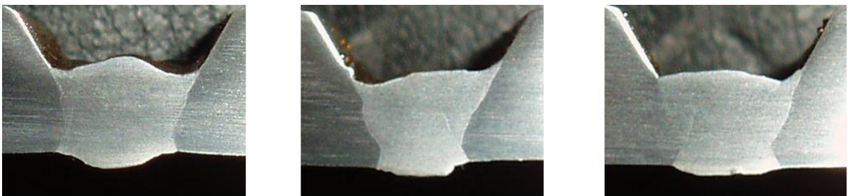
Slika 7. Utjecaj sekundarnog strujnog pulsa na oblik provara kod FastROOT postupka
