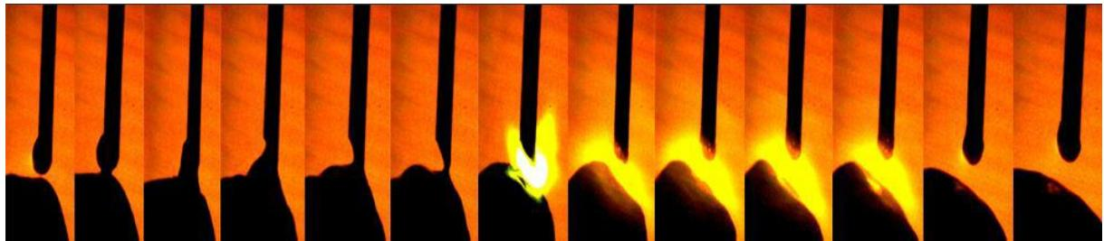
**Slika 6.** Način odvajanja kapljice pri FastROOT zavarivanju
