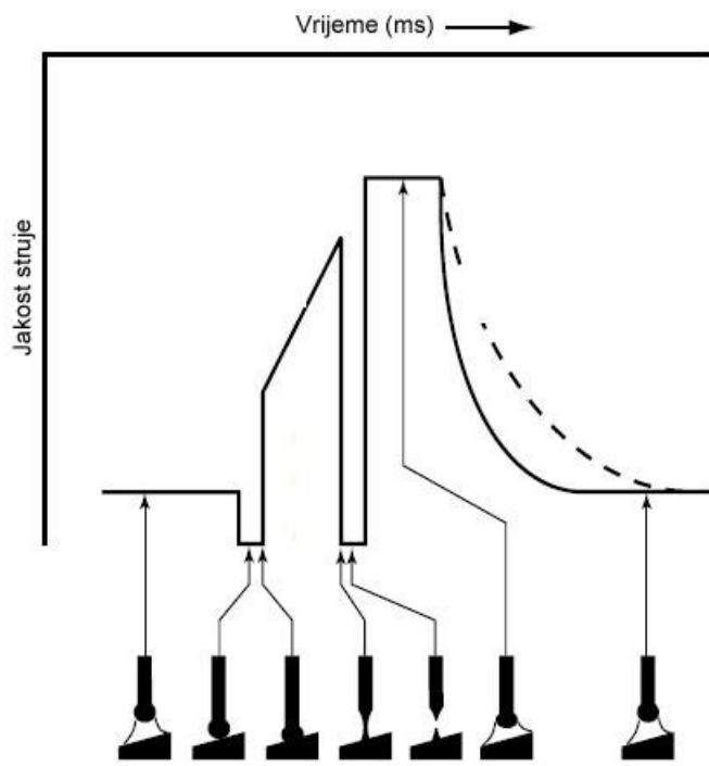
**Slika 5.** Prikaz dinamičke karakteristike izvora struje za STT postupak zavarivanja
