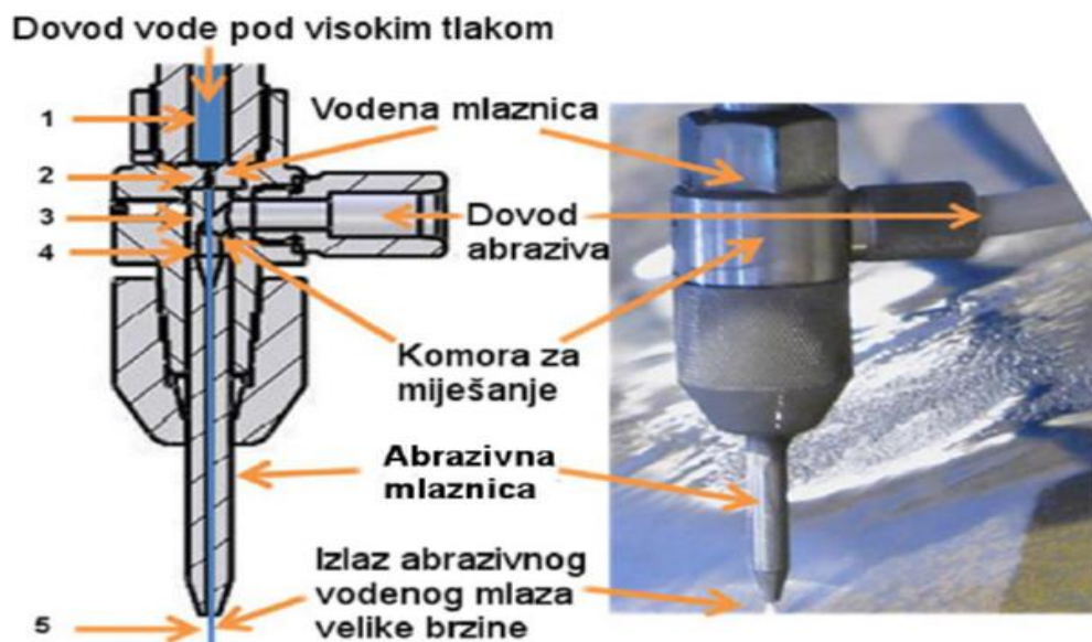
Slika 5. Abrazivna rezna glava
