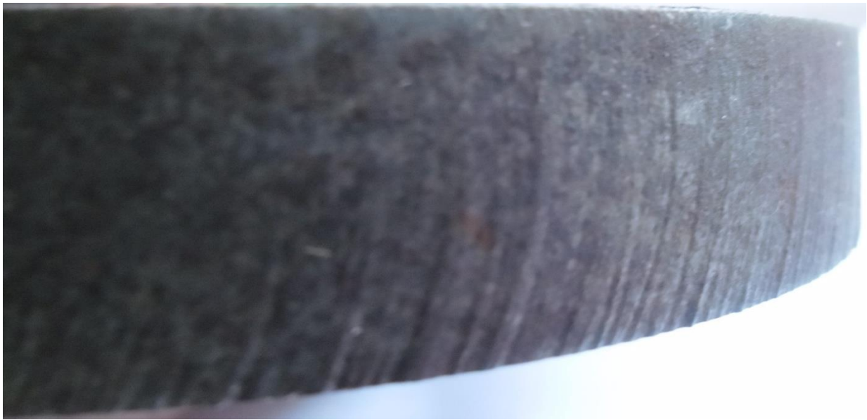
Slika 46. Zaostajanje mlaza prilikom obrade prirubnice
