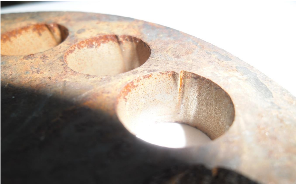
Slika 45. Pogreška nastala pri obradi promjera promjera 14 mm
