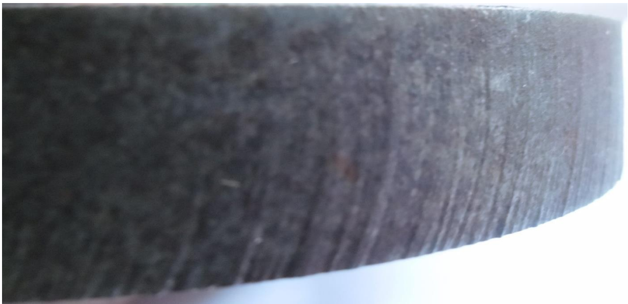
Slika 46. Zaostajanje mlaza prilikom obrade prirubnice
