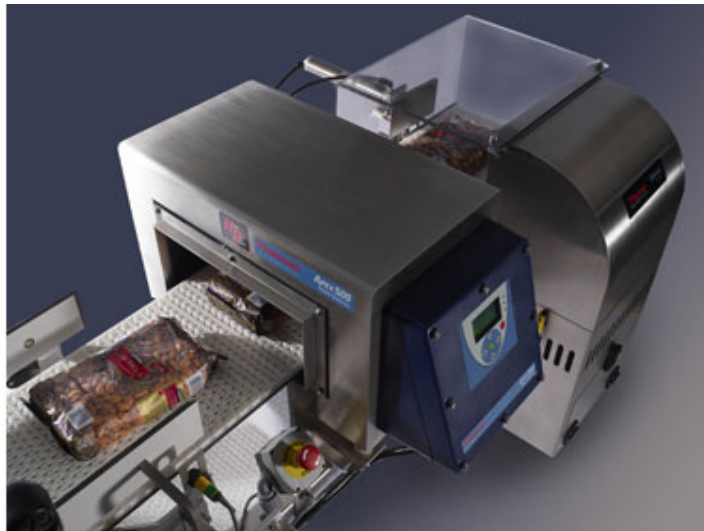
Ilustracija 2: Metal detektor s automatskih izbacivanjem kontaminiranog proizvoda
