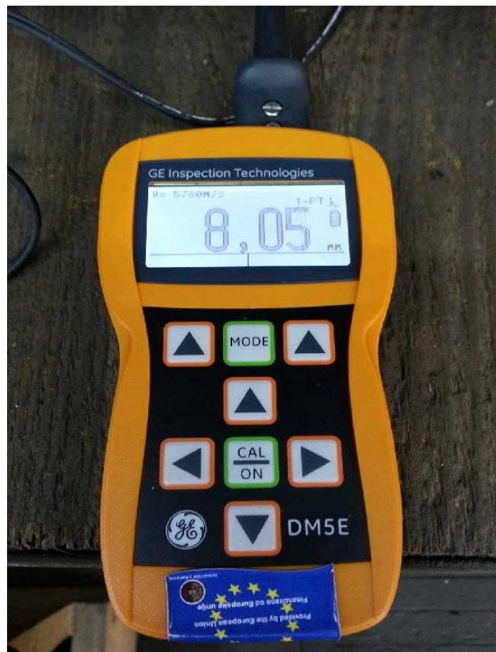
Slika 21. Ultrazvučni uređaj GE DM 5 E
