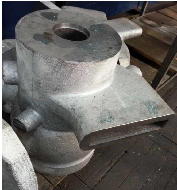
Slika 24. Odljevak od čeličnog lijeva očišćen i sa nanešenim gelom na površini.
