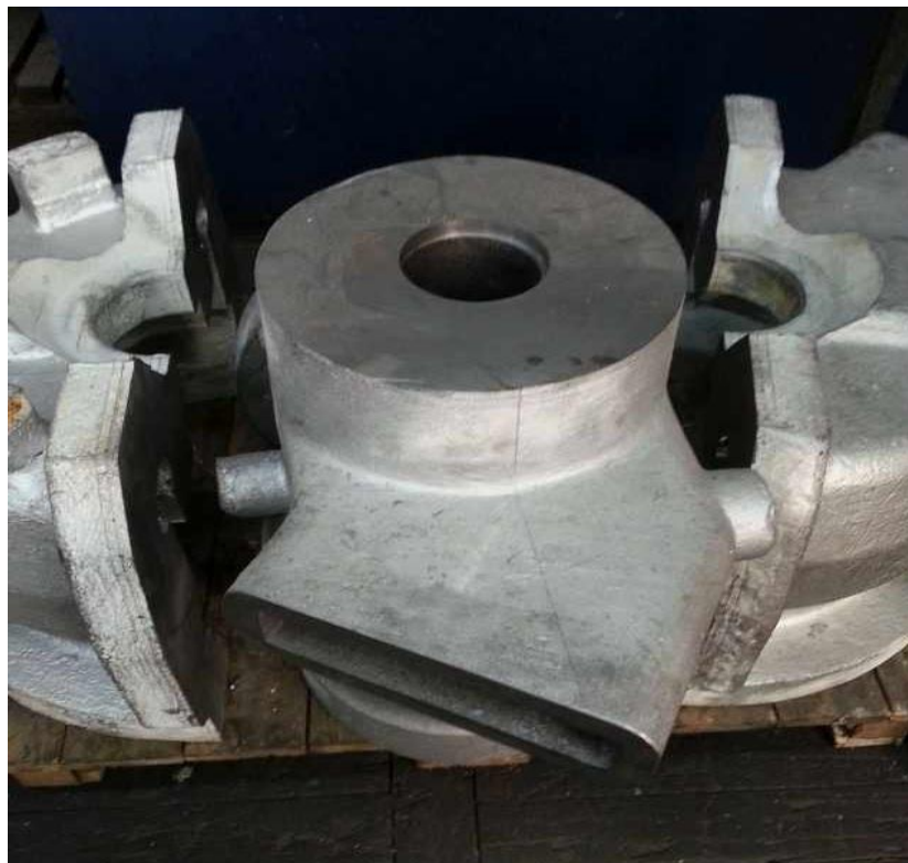
Slika 18. Odljevak od čeličnog lijeva
