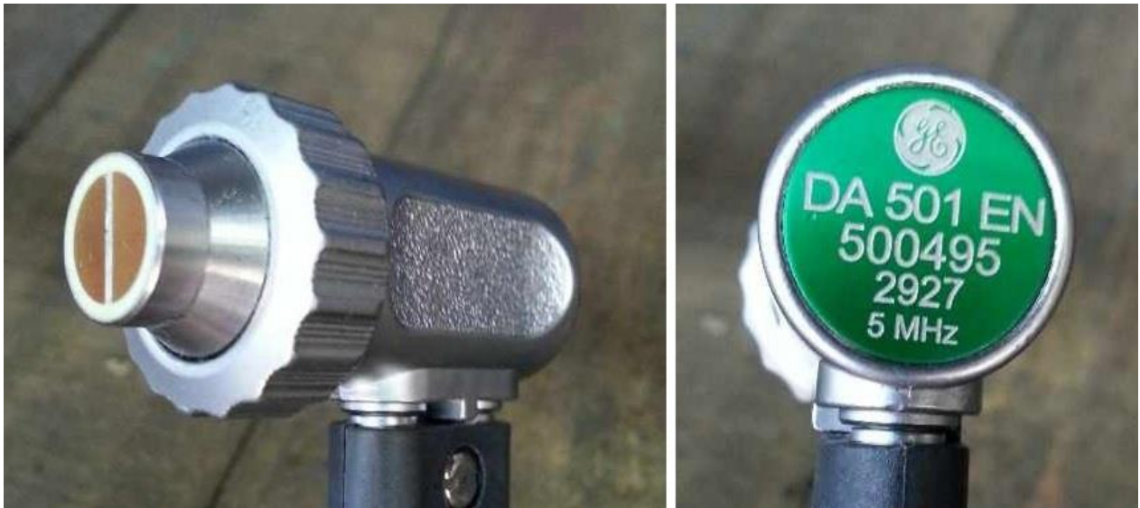
Slika 22. Sonda GE DA 501 EN
