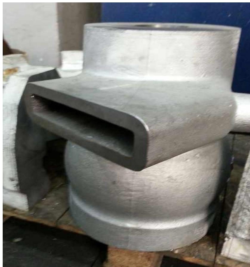
Slika 17. Odljevak od čeličnog lijeva
