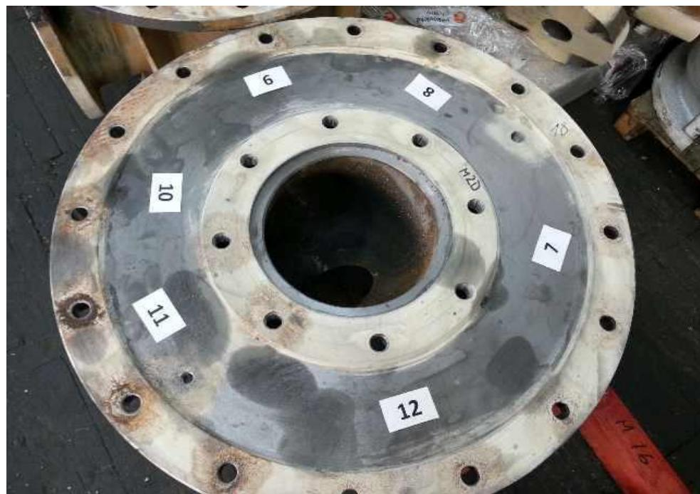
Slika 26. Odljevak od sivog lijeva očišćen, sa nanešenim gelom na površini i označenim mjestima mjerena.
