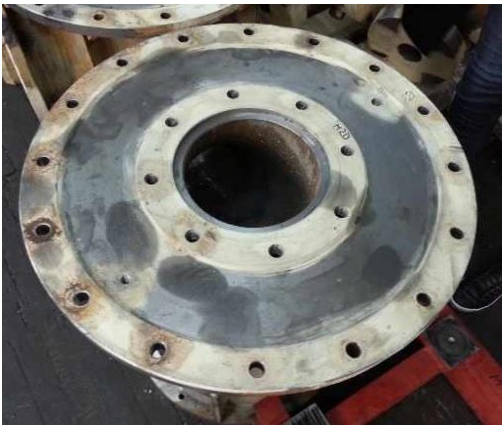
Slika 19. Odljevak od sivog lijeva
