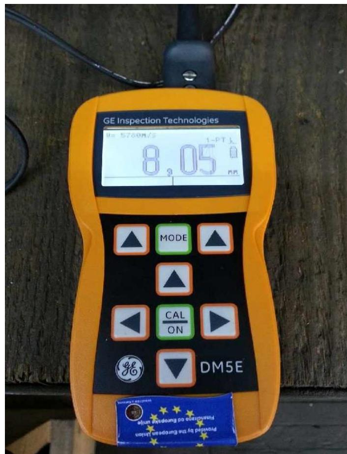
Slika 21. Ultrazvučni uređaj GE DM 5 E
