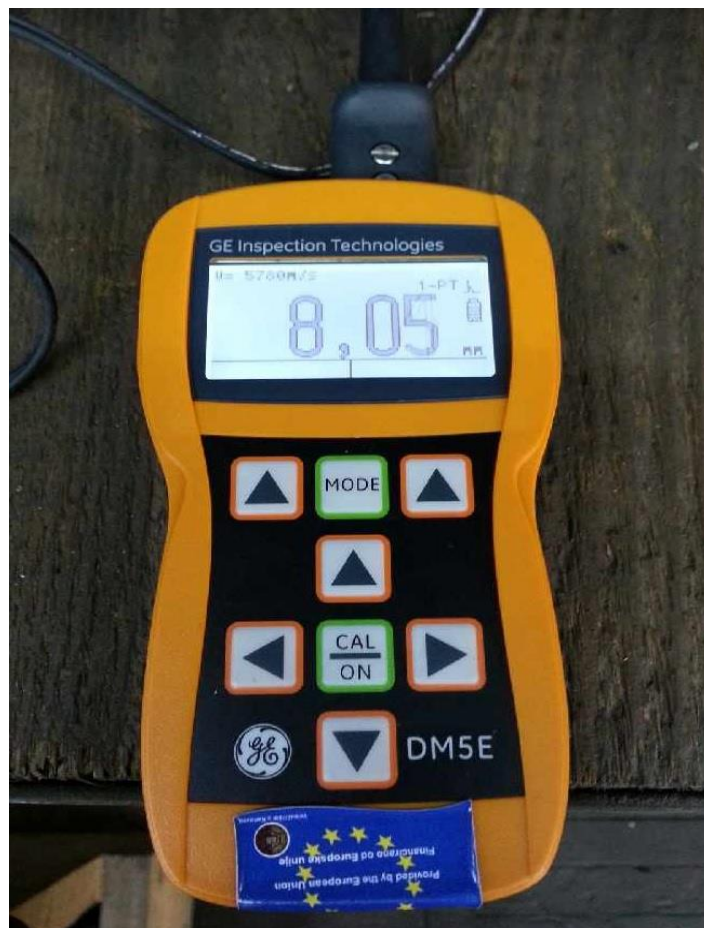
Slika 21. Ultrazvučni uređaj GE DM 5 E
