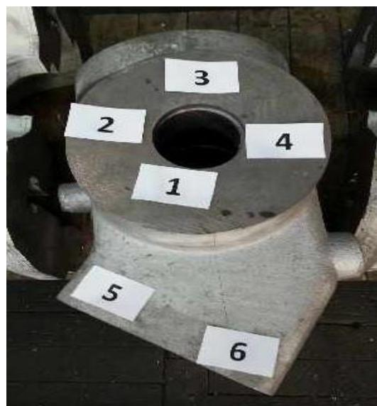
Slika 25. Označena mjesta na odljevku od čeličnog lijeva na kojima će se vršiti mjerjenja.
