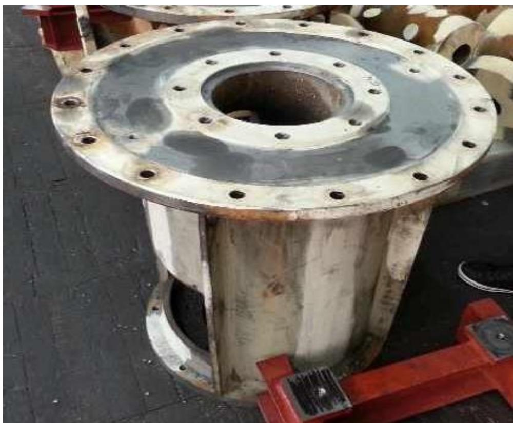
Slika 20. Odljevak od sivog lijeva
