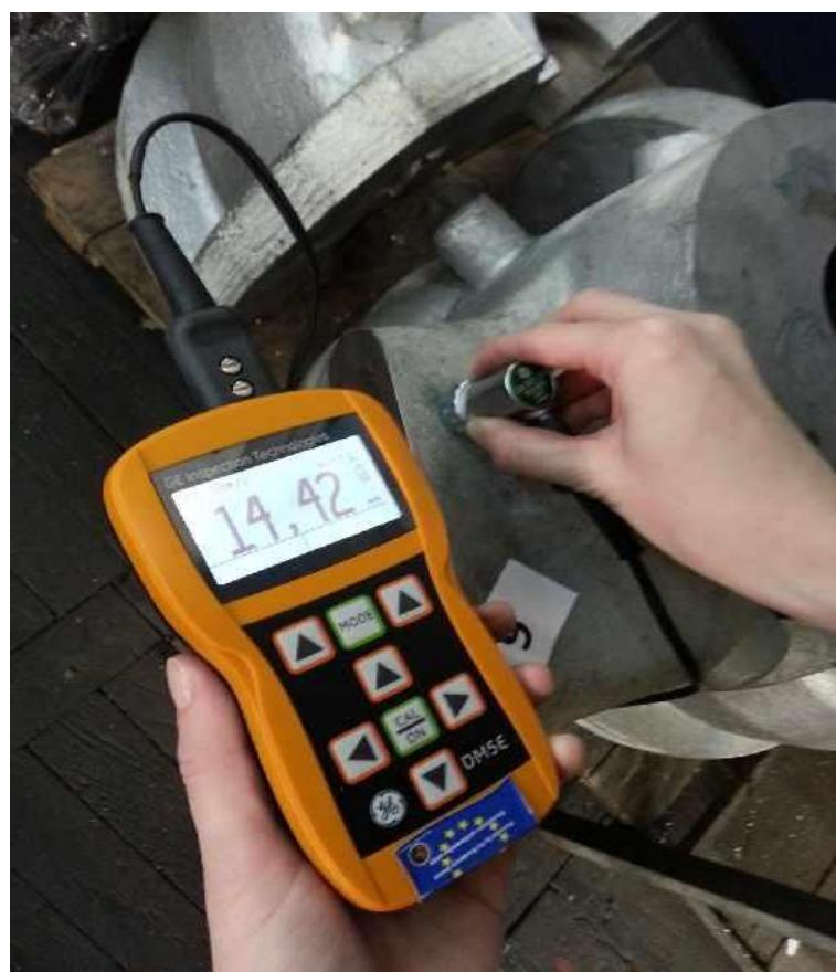
Slika 27. Mjerenje debljine stijenke odljevka ultrazvučnim uređajem.
