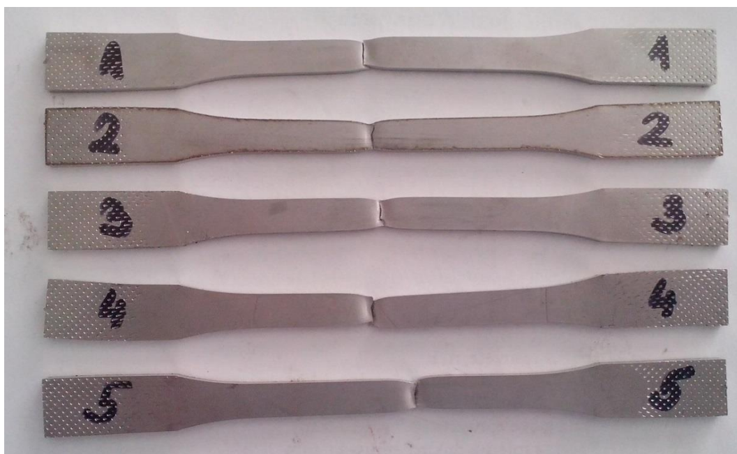
Slika 23. Epruvete nakon vlačnog ispitivanja
