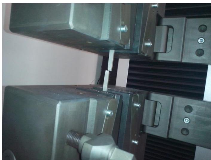
Slika 22. Epruveta nakon loma
