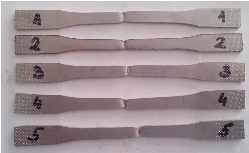
Slika 23. Epruvete nakon vlačnog ispitivanja
