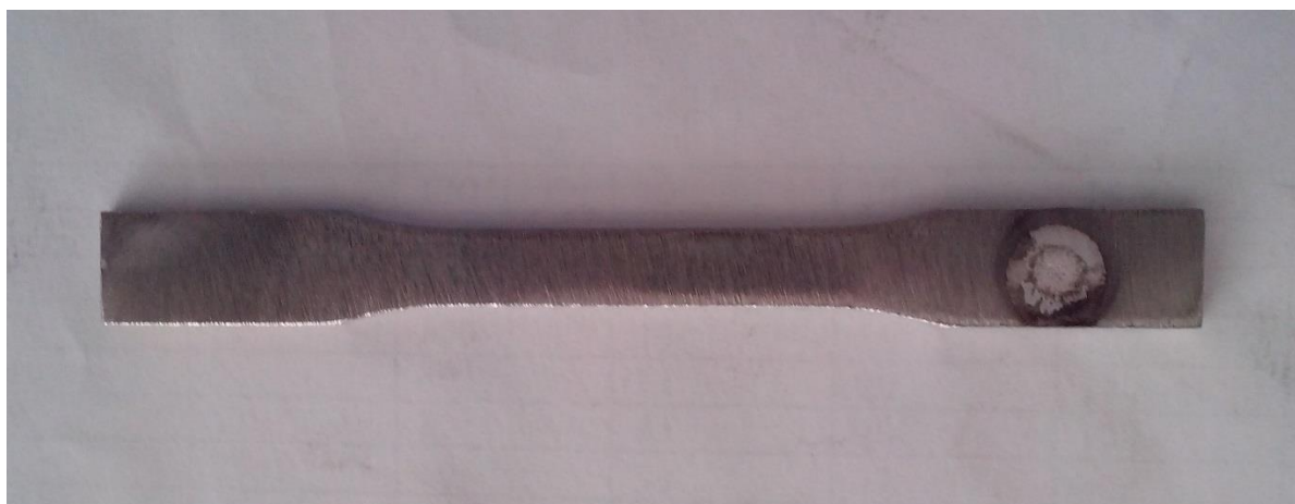
Slika 26. Izgled epruvete nakon ispitivanja tvrdoće po Brinell-u
