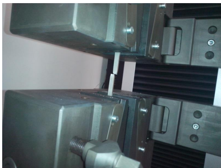
Slika 22. Epruveta nakon loma
