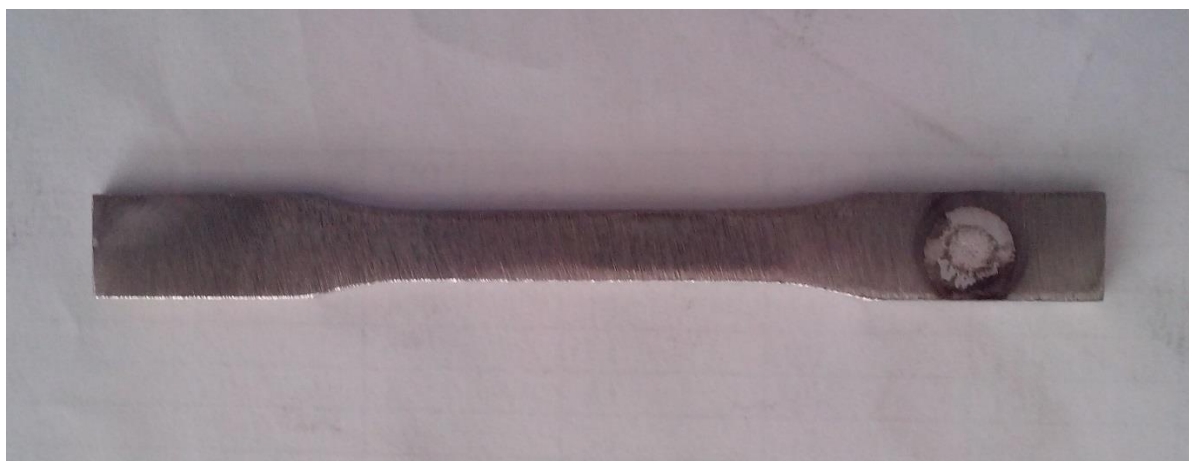
Slika 26. Izgled epruvete nakon ispitivanja tvrdoće po Brinell-u
