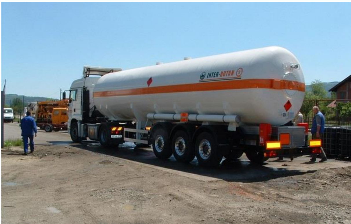
Slika 6. Autocisterna za prijevozu ukapljenog naftnog plina[6]
