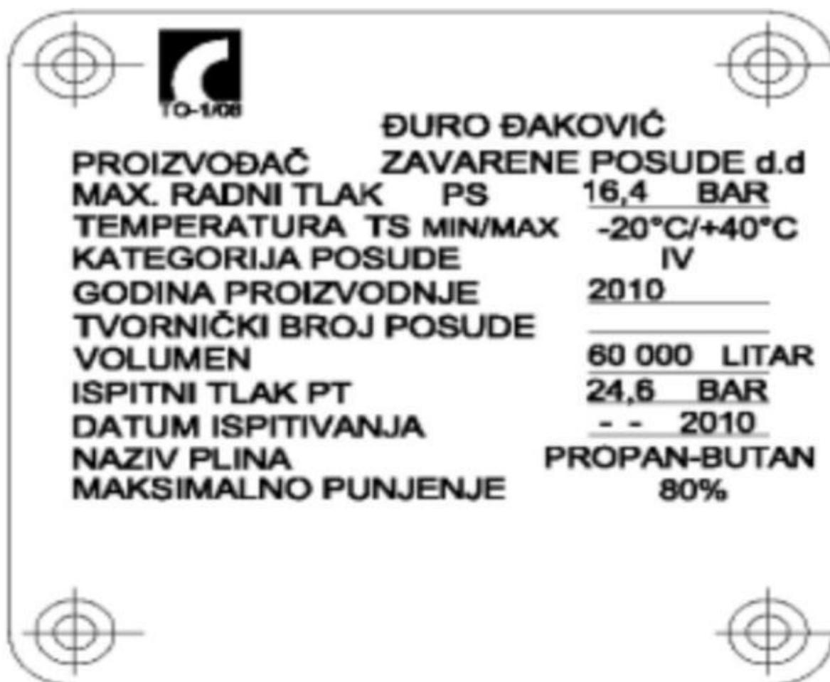
Slika 11. Prikaz pločice za propan-butan[11]
