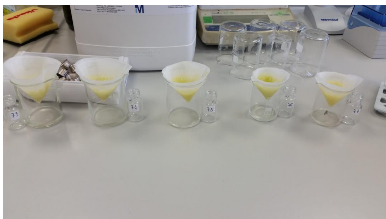
Slika 3. Priprema uzoraka arome za headspace bočice, filtriranjem preko filter papira. (Autor: Ivana Horvat 24.4.2017. godine)
