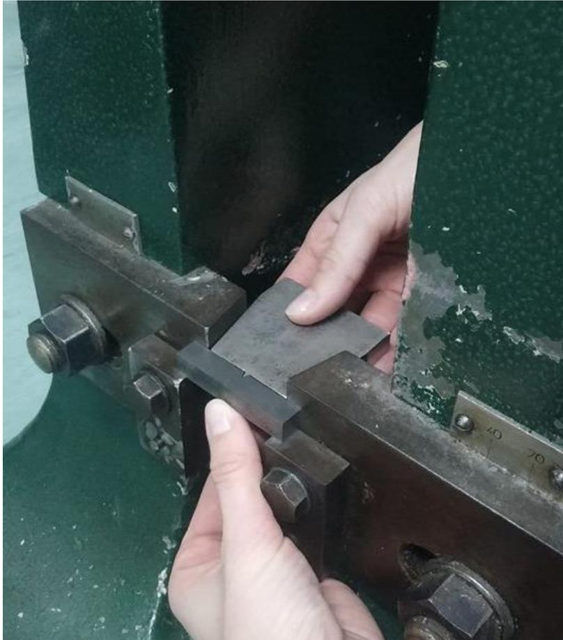
*Slika 39. Namještanje epruvete*
