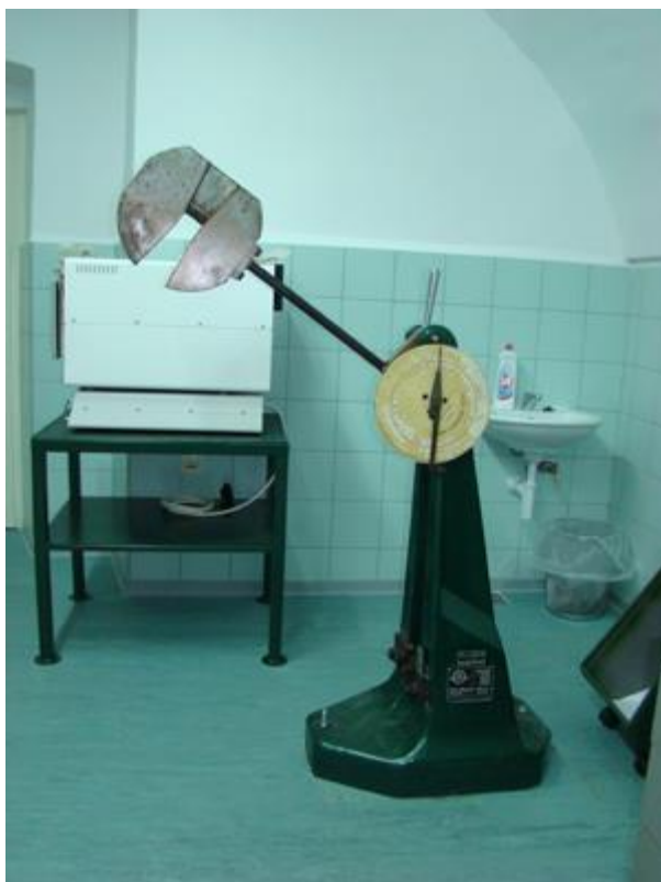
Slika 41. Charpyev bat prije ispitivanja
