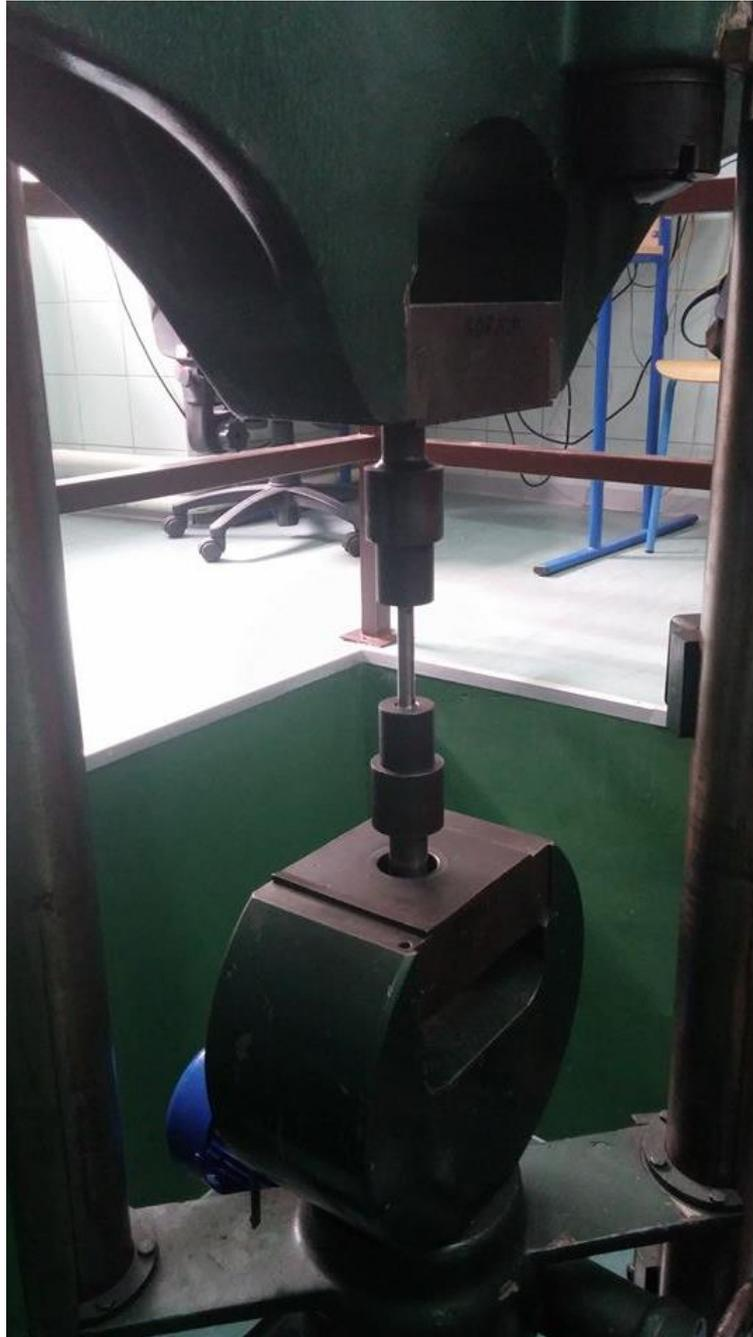
*Slika 26. Učvršćena probna epruveta*
