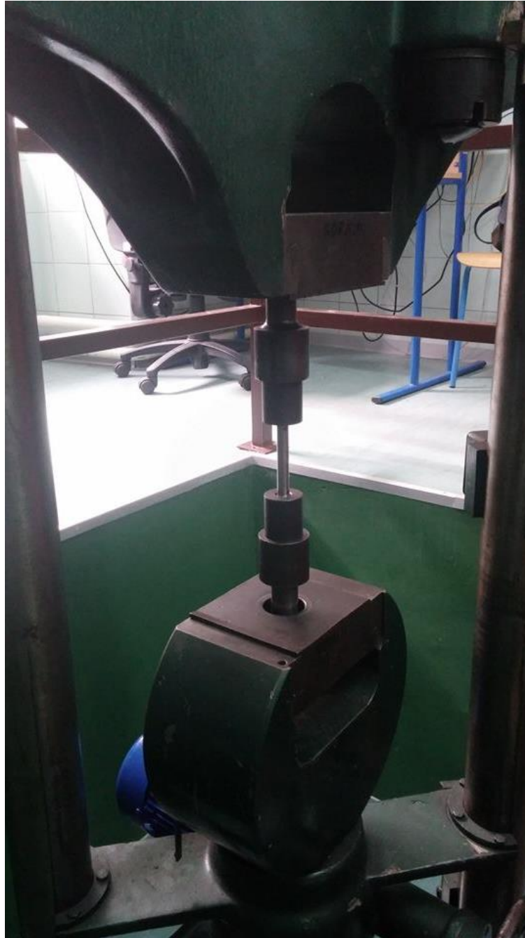
Slika 26. Učvršćena probna epruveta
