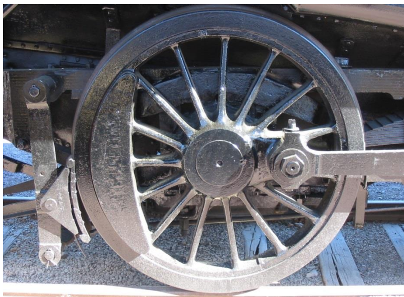
Slika 10. Čelični lijev za strojogradnju [5]
