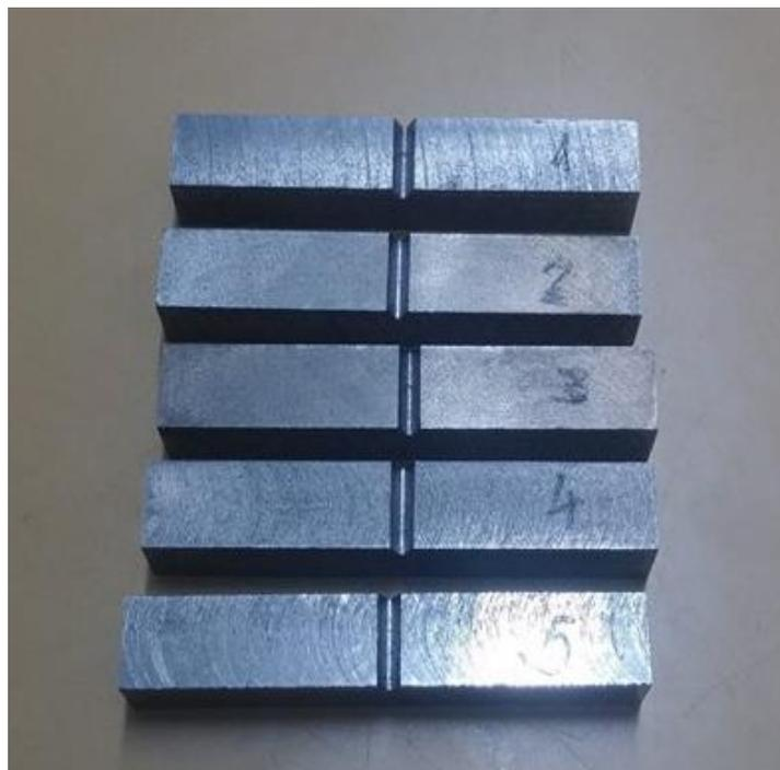
*Slika 38. Epruvete za ispitivanje udarnog rada loma*
