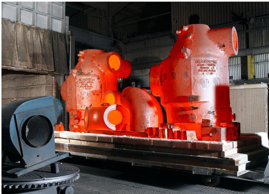
Slika 9. Čelični lijev nakon 12 sati toplinske obrade[5]
