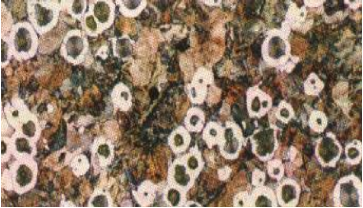
Slika 20. Mikrostruktura perlitnog nodularnog lijeva [7]
