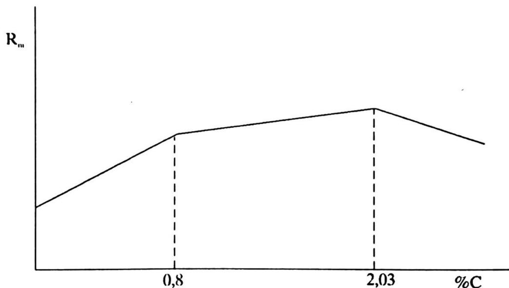
Slika 5. Shematski prikaz promjene vlačne čvrstoće s porastom % C u Fe-Fe<sub>3</sub>C legurama[3]
