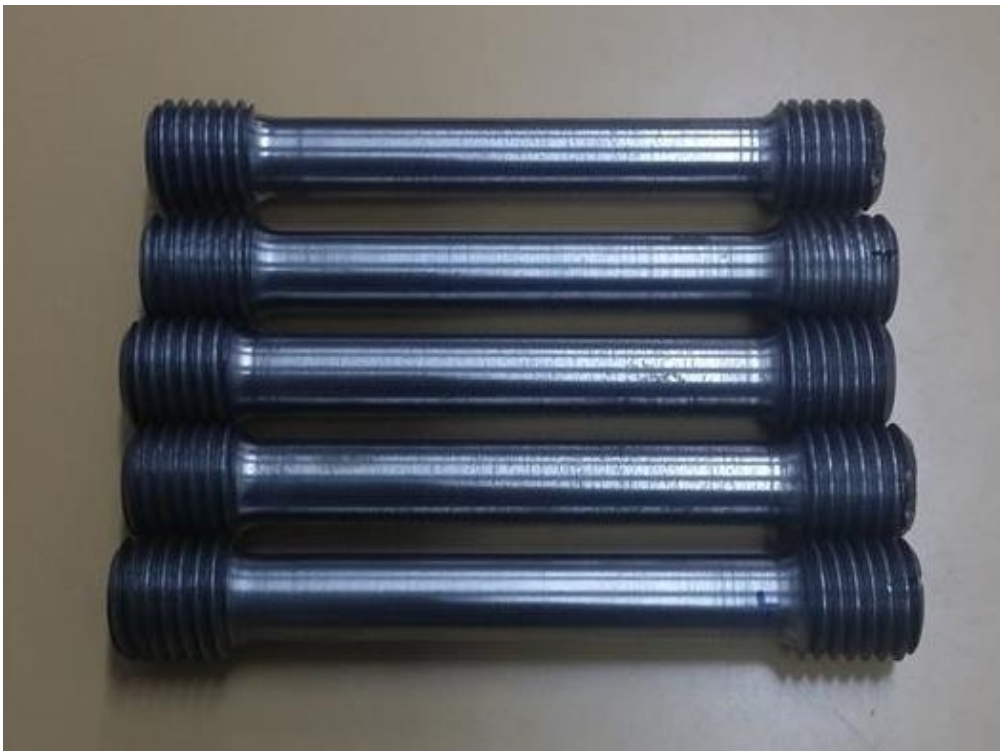
Slika 22. Epruvete za ispitivanje vlačne čvrstoće
