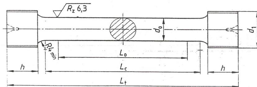
Slika 23. Okrugle epruvete s navojnim glavama [8]
