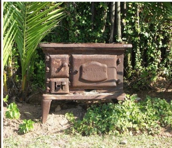
*Slika 13. Primjena sivog lijeva[6]*
