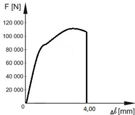
Slika 29. Dijagram kidanja za epruvetu 1
