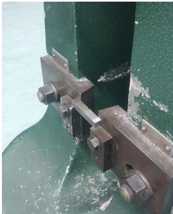
*Slika 40. Namještena epruveta*
