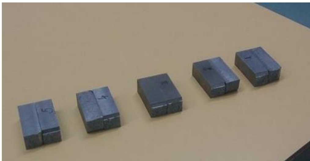
Slika 43. Epruvete nakon pucanja
