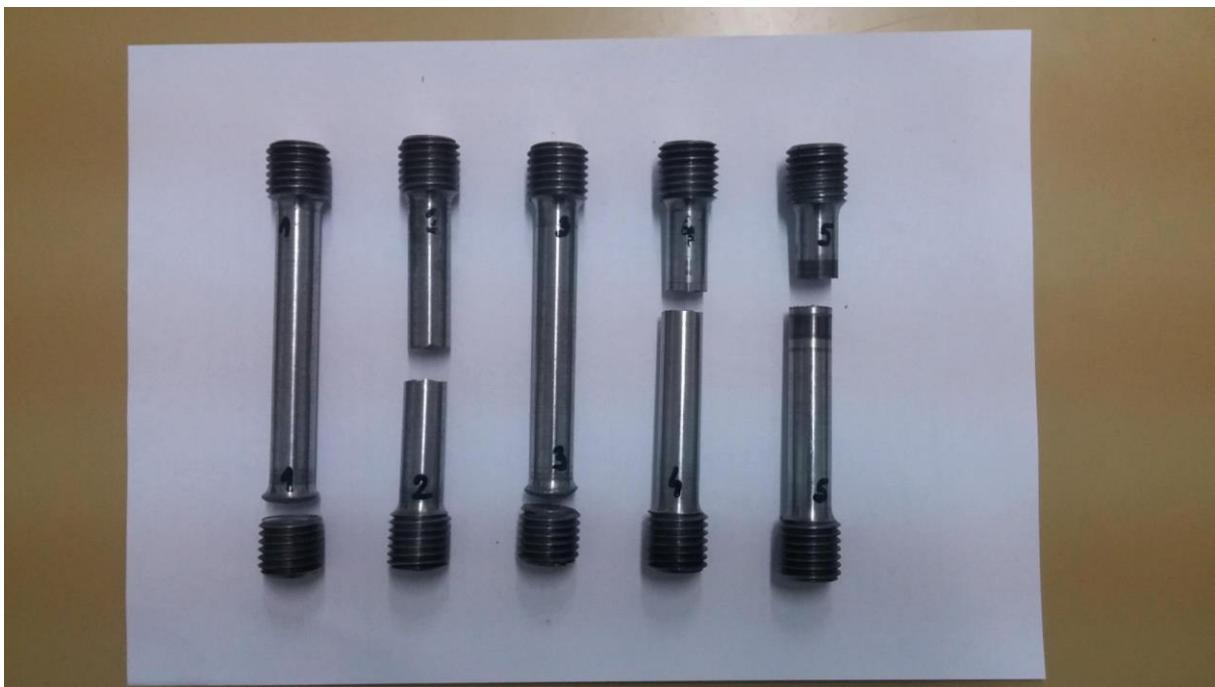
Slika 28. Polomljene epruvete
