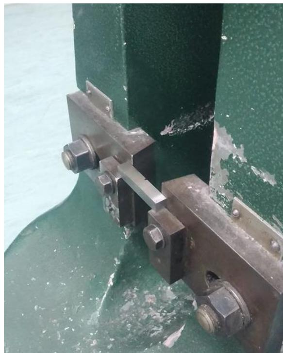
Slika 40. Namještena epruveta
