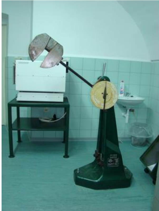
Slika 41. Charpyev bat prije ispitivanja
