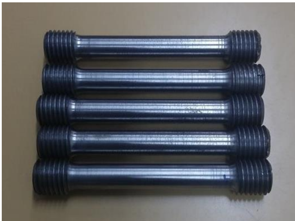
Slika 22. Epruvete za ispitivanje vlačne čvrstoće
