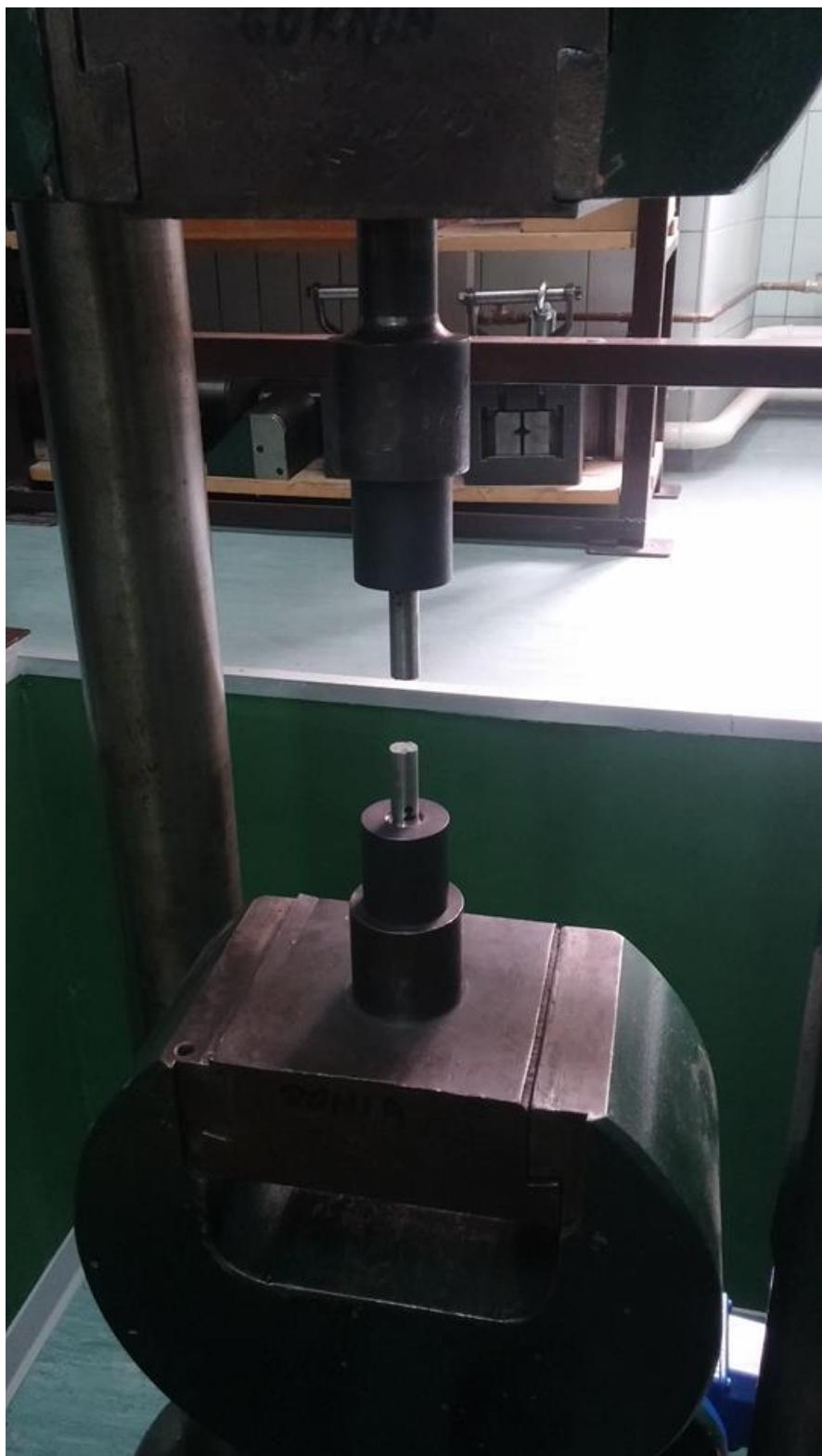
*Slika 27. Epruveta nakon opterećenja*
