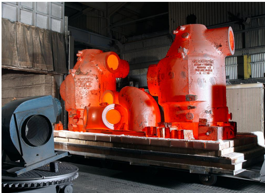
Slika 9. Čelični lijev nakon 12 sati toplinske obrade[5]
