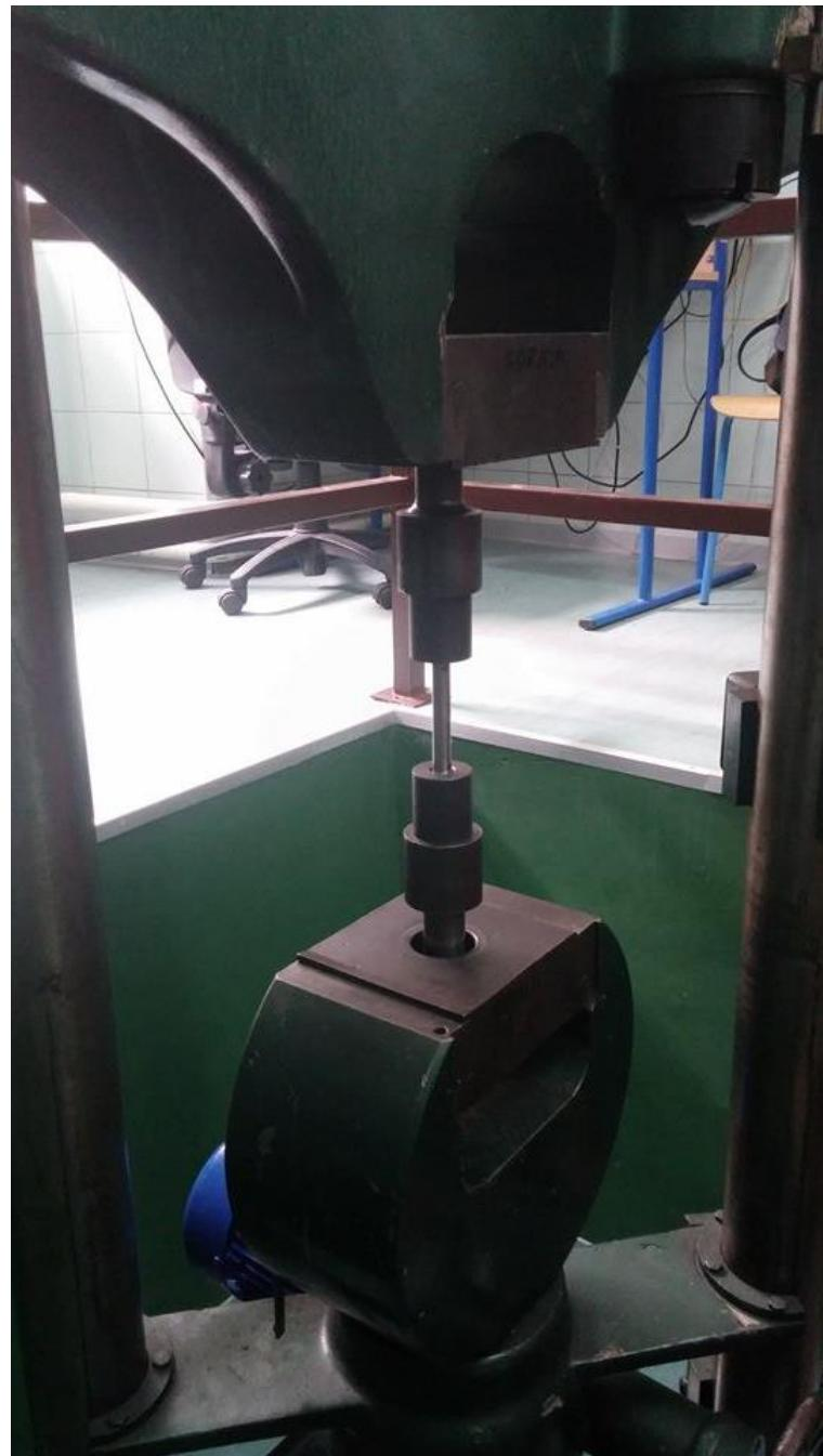
Slika 26. Učvršćena probna epruveta
