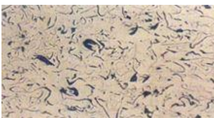
Fosfidni eutektikum, obojen, nagrizano fericijanidom, povećanje 100X
