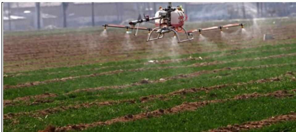
Slika 22. Dron prilikom zaštite usjeva (<http://droneselect.com>)
