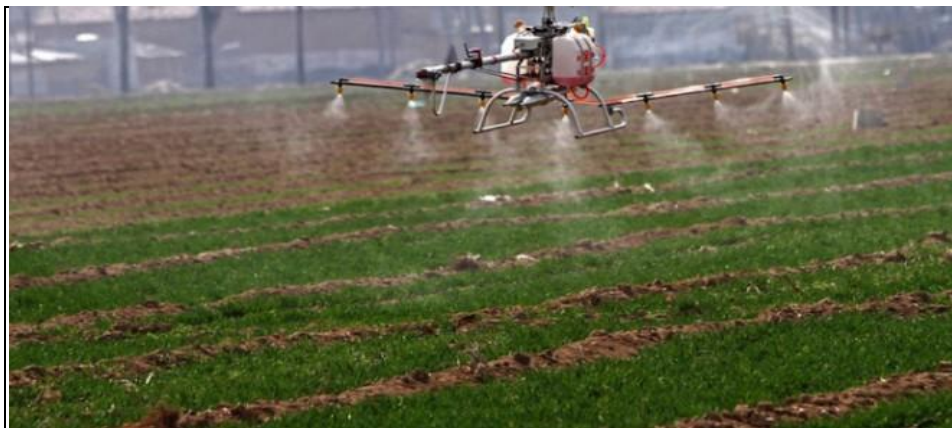
Slika 22. Dron prilikom zaštite usjeva ( http://dronesselect.com )
