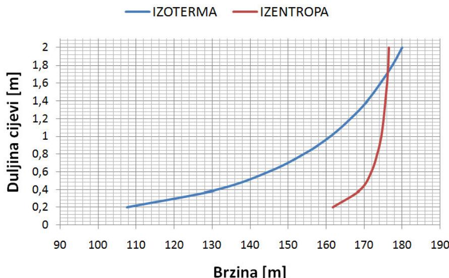
Slika 21. Ovisnost izlazne brzine o promjeni duljine cijevi.
