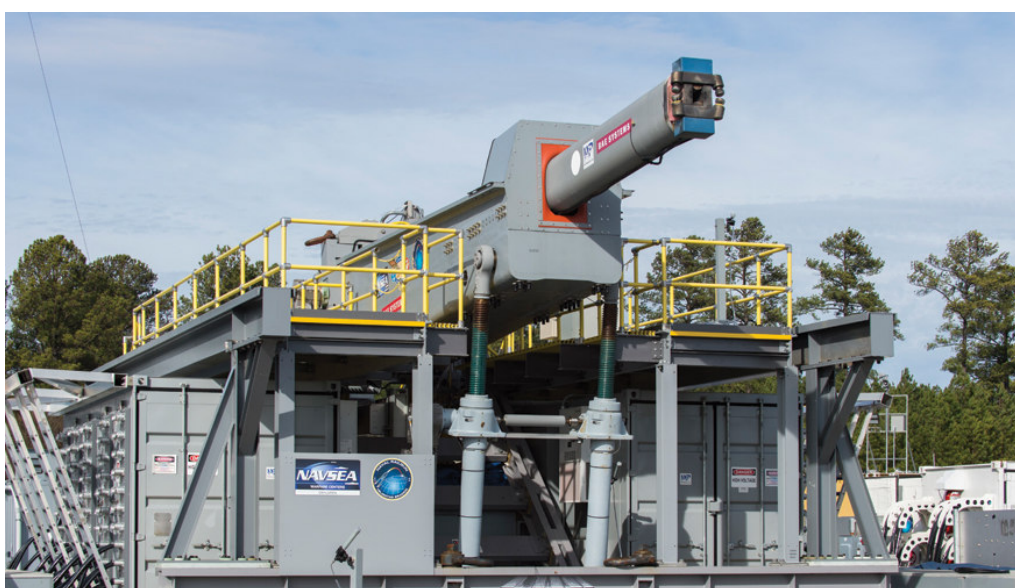
Slika 19. Elektromagnetski top američke mornarice na testnom poligonu.[27]
