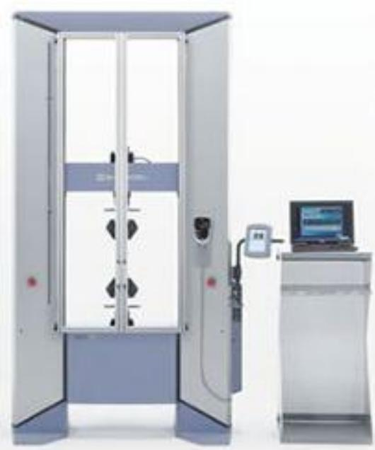
Slika 31. Kidalica Shimadzu AG-Xplus [40]
