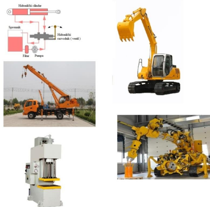
Slika 3. Primjeri hidrauličkih linearnih pogona
