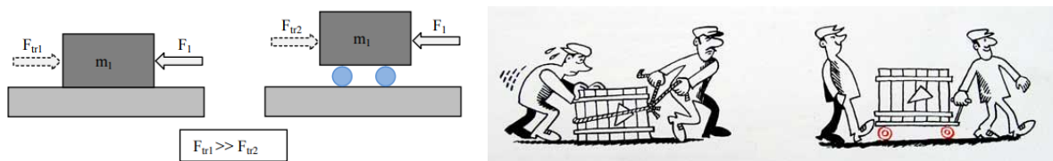
Slika 13. Prikaz razlike trenja kotrljanja i trenja klizanja
