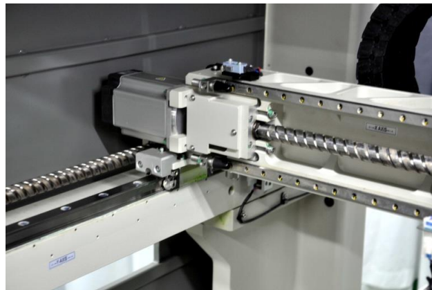
Slika 12. Primjer pogona na kuglično vreteno
