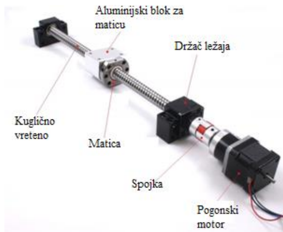
Slika 11. Građa pogona na kuglično vreteno
