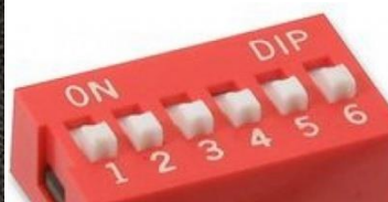
Slika 57. Logička kombinacija za odabir jačine struje
