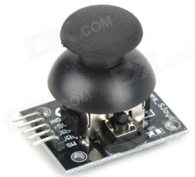
Slika 91. Izgled odabranog joystick modula
