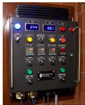
Slika 79. Primjer upotrebe LED indikatora
