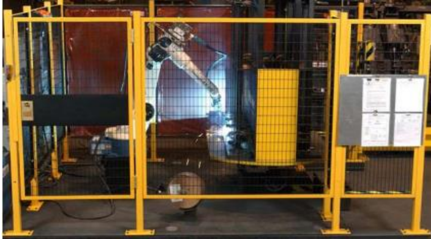
Sl. 15. Zaštitna ograda od pletene žice
