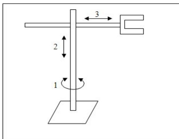
Sl. 5. Cilindrična konfiguracija robota
