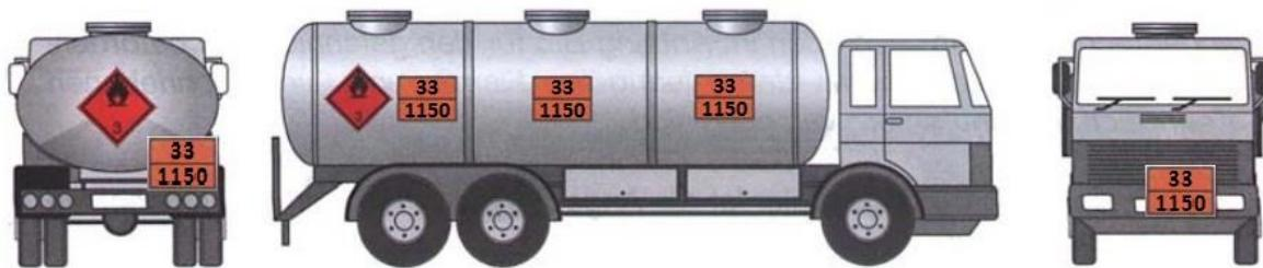
Slika 19. Označavanje vozila za prijevoz etilen diklorida
