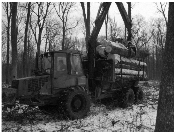
Slika 16. Istraživani forvarder Valmet 840.2 u radu [13]
