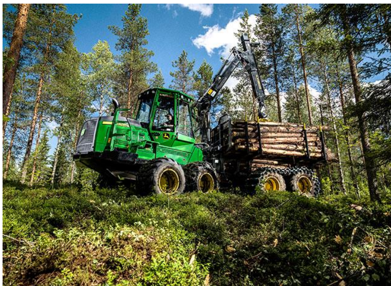
Slika 1. Izvoženje drva forvarderom
