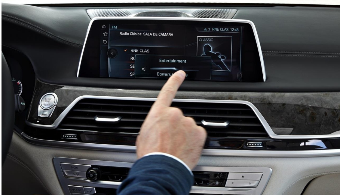
Slika 3. - iDrive u vozilu BMW serije 7. [7]
