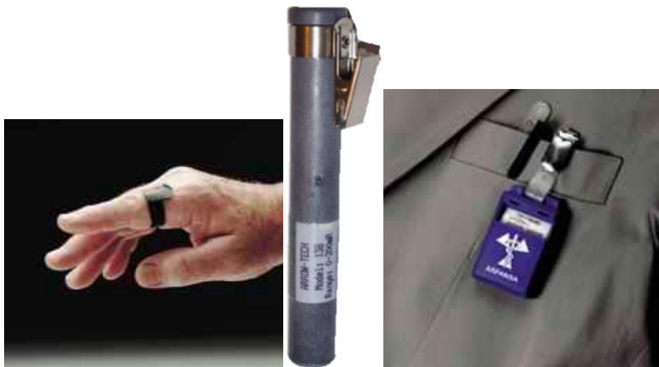
SI.14;15;16. Prikazane su različite izvedbe dozimetara (za prst, kao olovka i kao paket) izvor: http://161.53.18.5/static/erg/2001/kovac/d1.html
