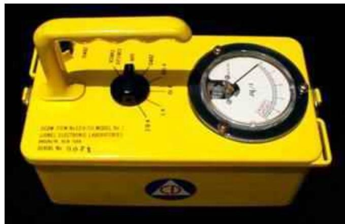
**Sl.13.** uređaj za mjerenje kontaminiranosti
