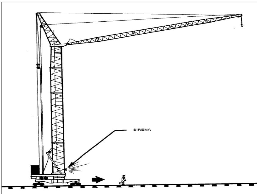
Slika 7 Primjer zvučnog signala na toranjskoj dizalici
