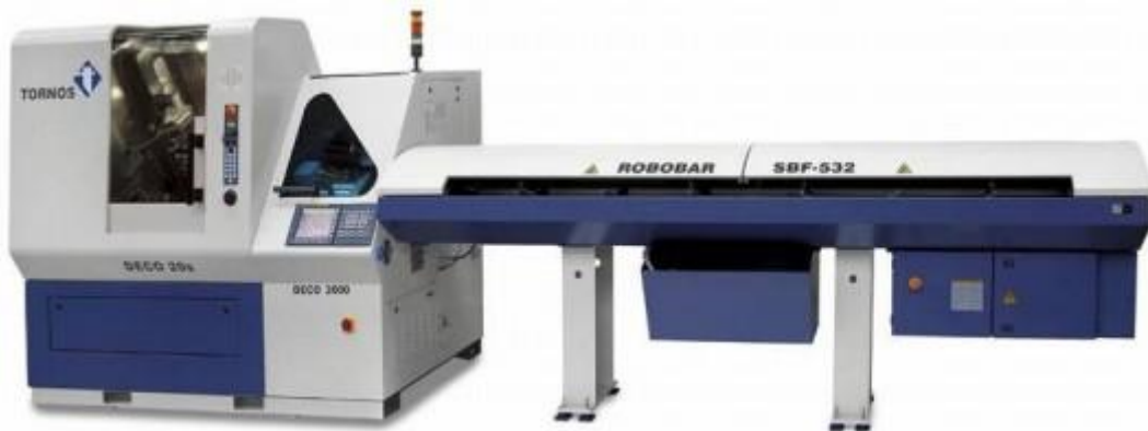
Slika 21. Stroj za izmjenu obradaka vođenjem šipke kroz glavno vreteno
