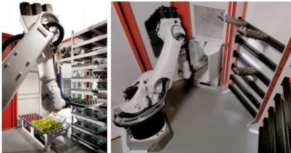
Slika 18. Primjeri Hermle sustava za rukovanje obradcima Kuka robotima
