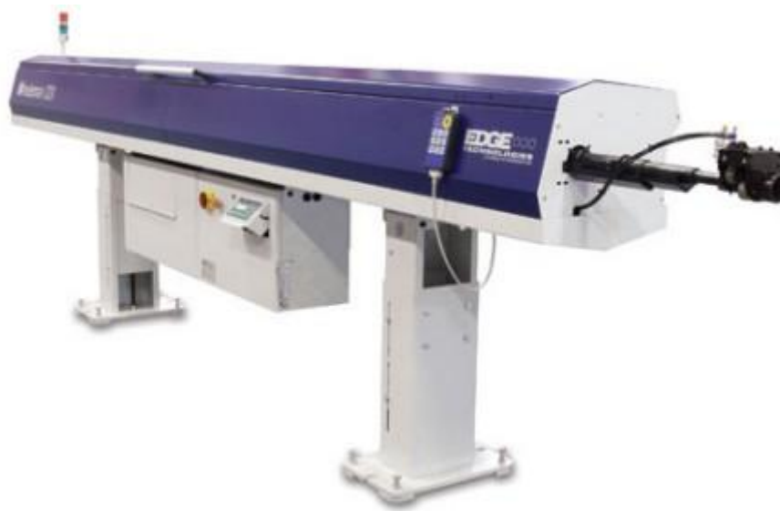
Slika 19. Stroj za ulaganje EDGE Minuteman
