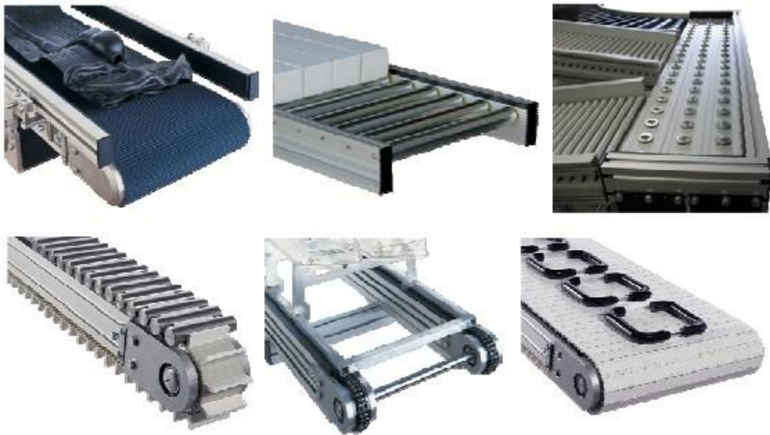
Slika 23. Različiti prijenosni elementi konvejera: a) trake, b) valjci, c) kuglični elementi, d) klinasti remen, e) lanci, f) plastični elementi
