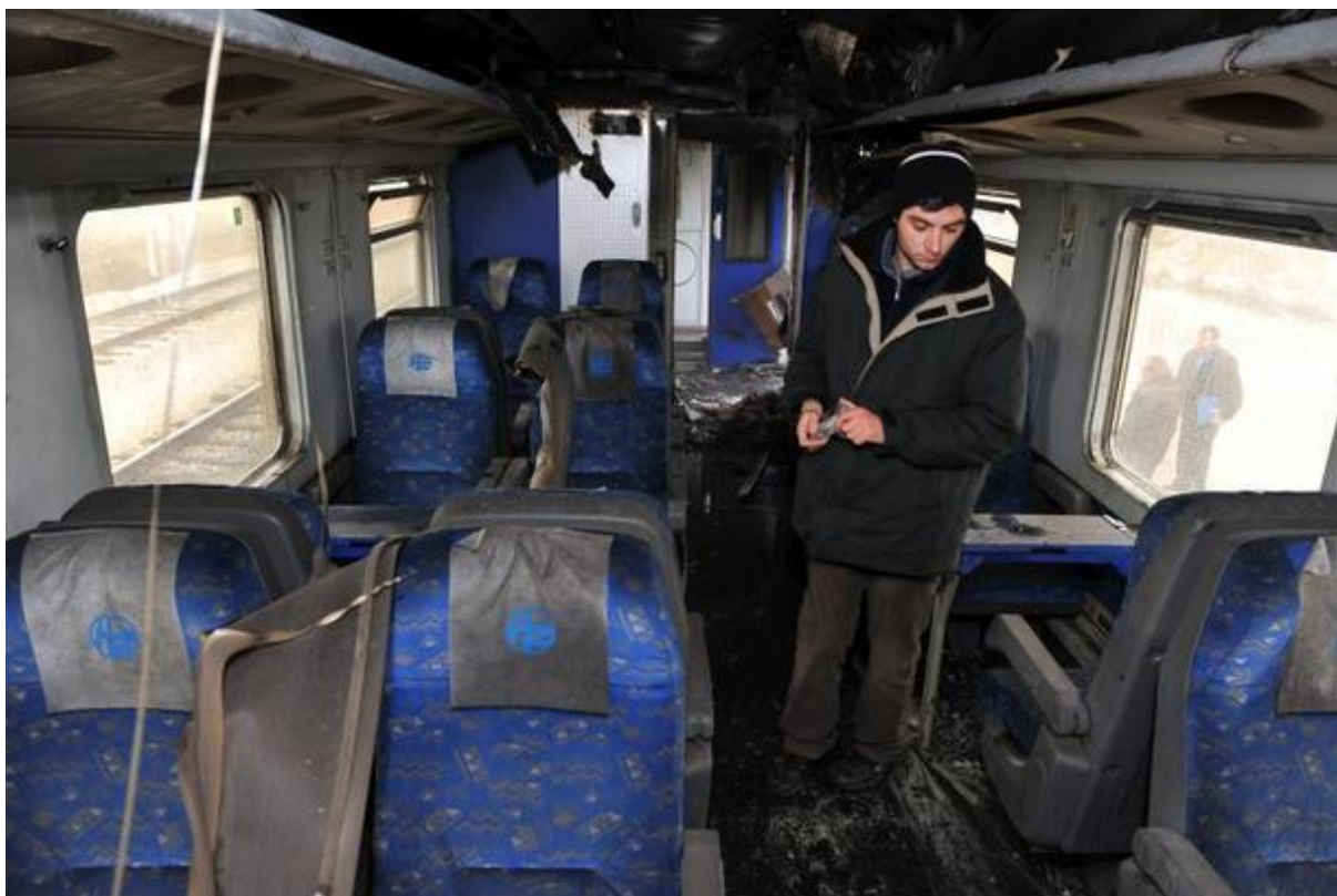
Sl. 12. Unutrašnjost putničkog vagona nakon požara [23]
