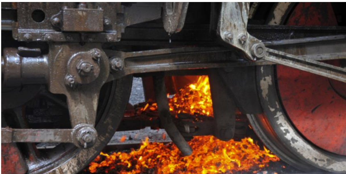
Sl. 13. Požar na željezničkoj pruzi nakon naglog kočenja [25]
