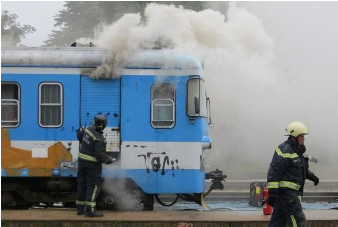
Sl. 10. Otvaranje kućišta motora zapaljenog vlaka [21]
