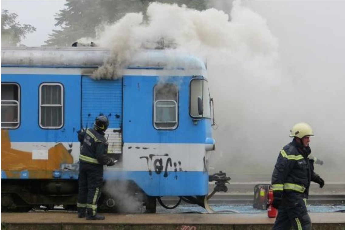
Sl. 10. Otvaranje kućišta motora zapaljenog vlaka [21]
