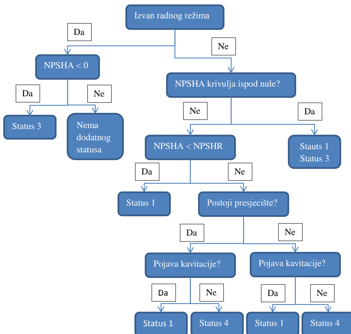
Sl. 6.2 Stablo odlučivanja u proračunu kavitacijske rezerve
