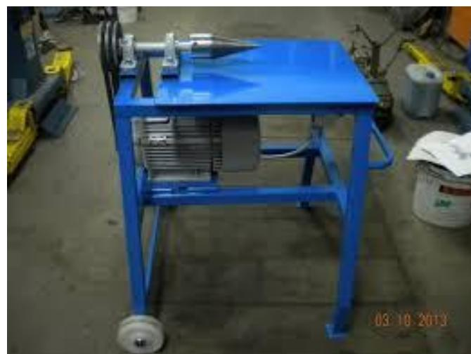
Slika 9. Električni cjepač za drva sa svrdlom. [8]
