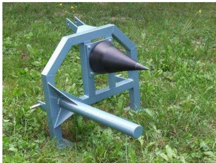
Slika 7. Cjepač za drva sa svrdlom. [6]
