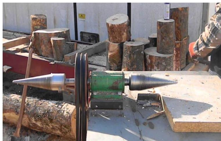
Slika 10. Obostrani električni cjepač za drva sa svrdlom.
