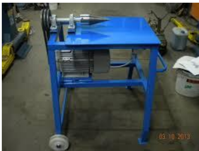
Slika 9. Električni cjepač za drva sa svrdlom. [8]
