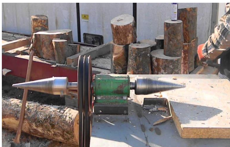
Slika 10. Obostrani električni cjepač za drva sa svrdlom.
