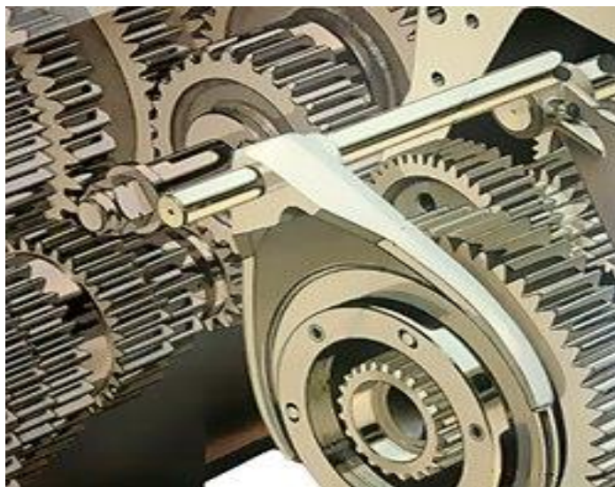
Slika 4. Primjeri strojnih dijelova koji se kružno gibaju i opasna mjesta oko njih[3]
