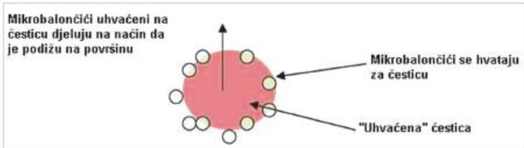
Slika 7. Čestice u modulu za flotaciju
