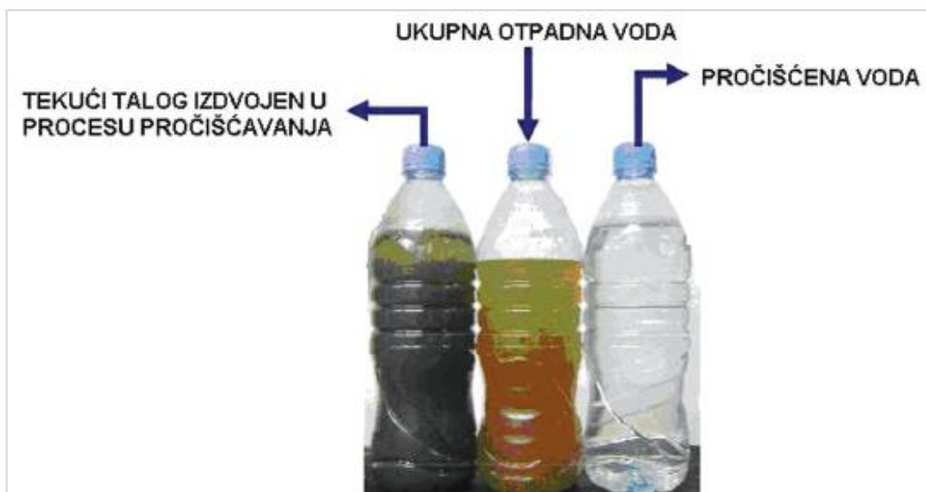
Slika 2. Pročišćavanje otpadne vode
