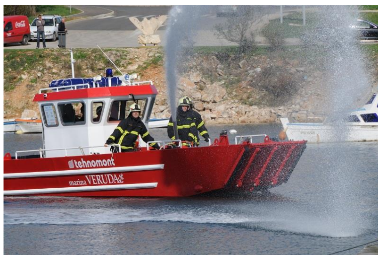
Sl. 7. Prikaz gašenja požara s vatrogasnog plovila [12]
