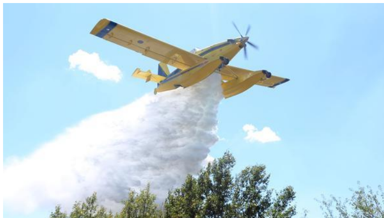
Sl. 9. Prikaz gašenje požara bacanjem vodene bombe iz airtraktora [15]
