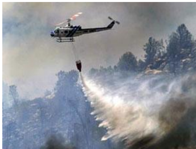
Sl. 8. Prikaz gašenja požara helikopterom pomoću kruške [13]
