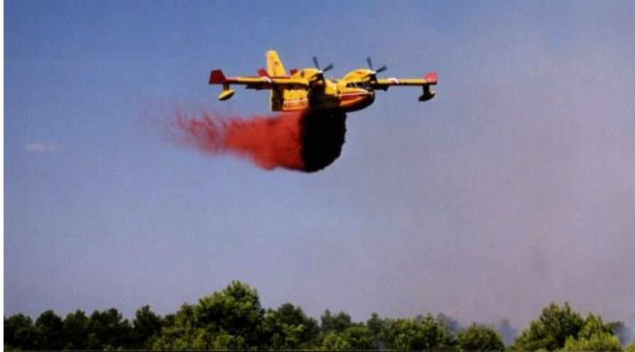
Sl. 1. Prikaz bacanja reterdanata iz zrakoplova [5]
