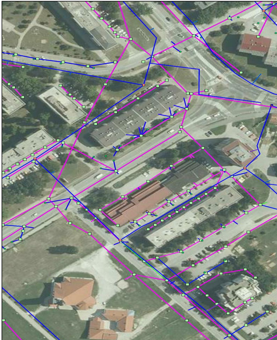
Slika 3. Shema priključaka vodovoda i kanalizacije
