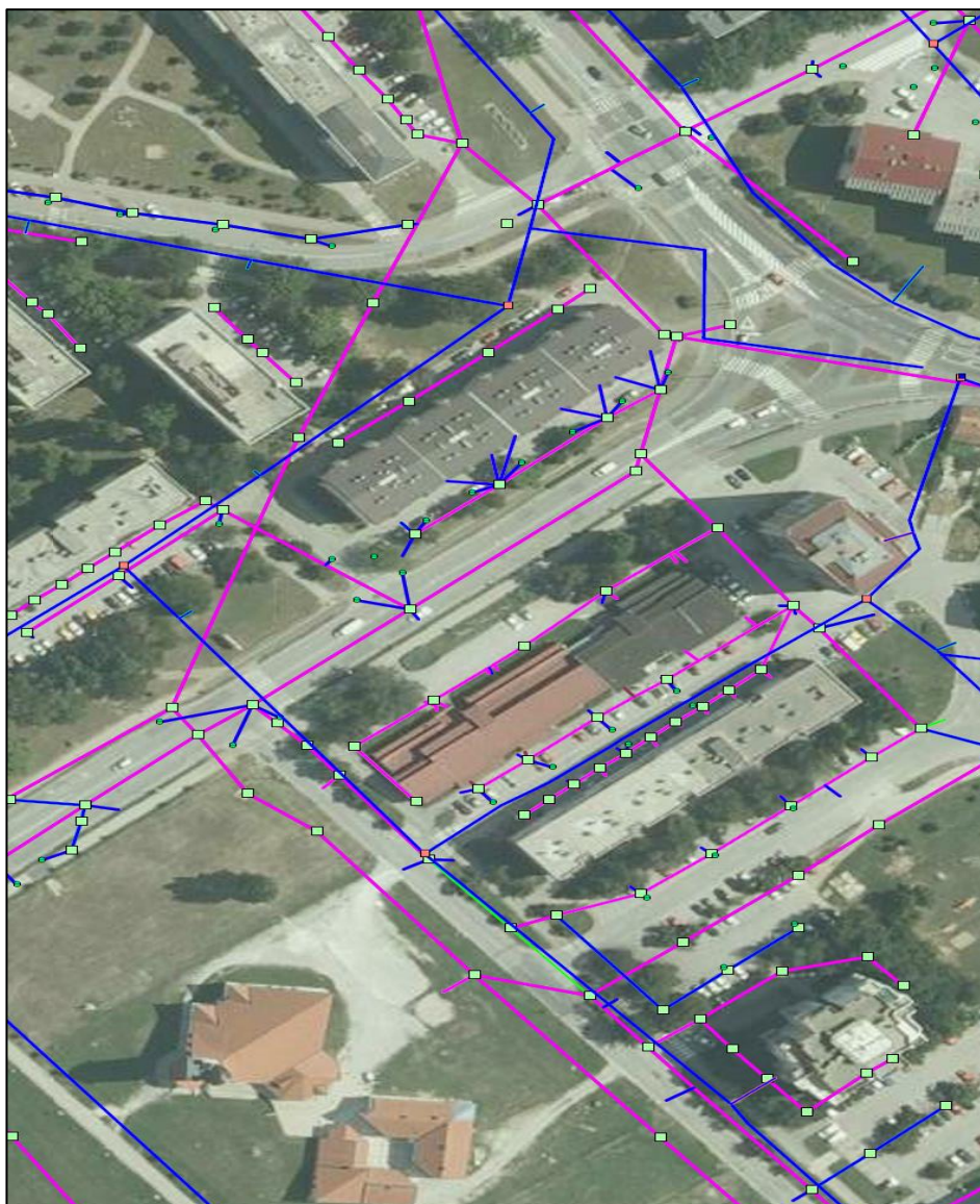
Slika 3. Shema priključaka vodovoda i kanalizacije
