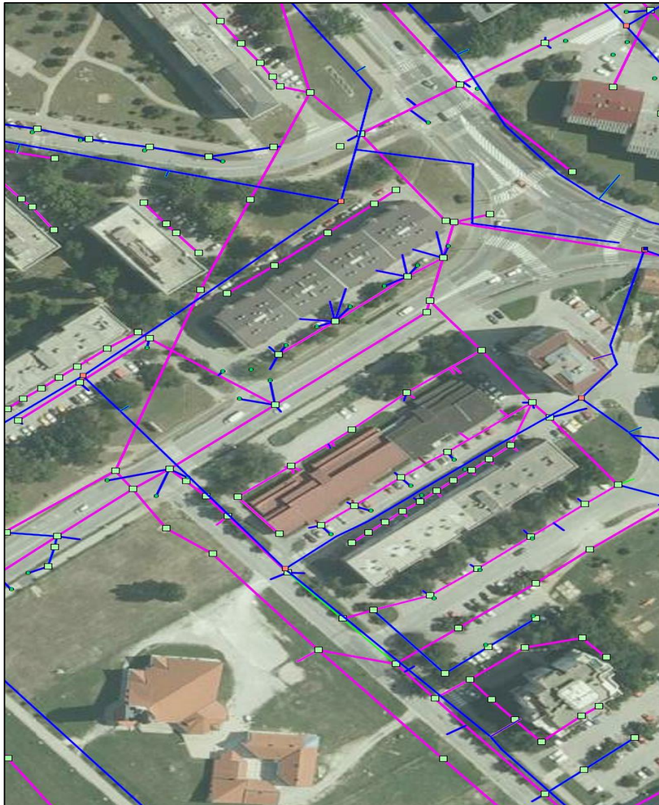
Slika 3. Shema priključaka vodovoda i kanalizacije
