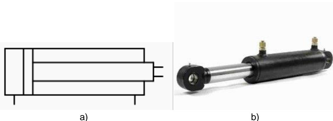
Slika 2. a) Simbol cilindra, b) Stvarni izgled
