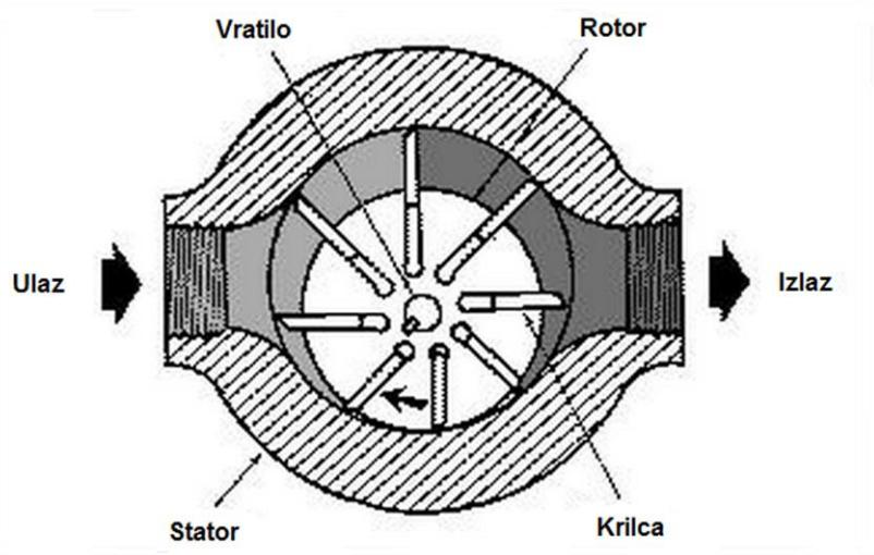
Slika 18. Krilni jednokomorni motor
