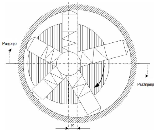
Slika 16. Radijalno klipni motor s ekscentričnim blokom
