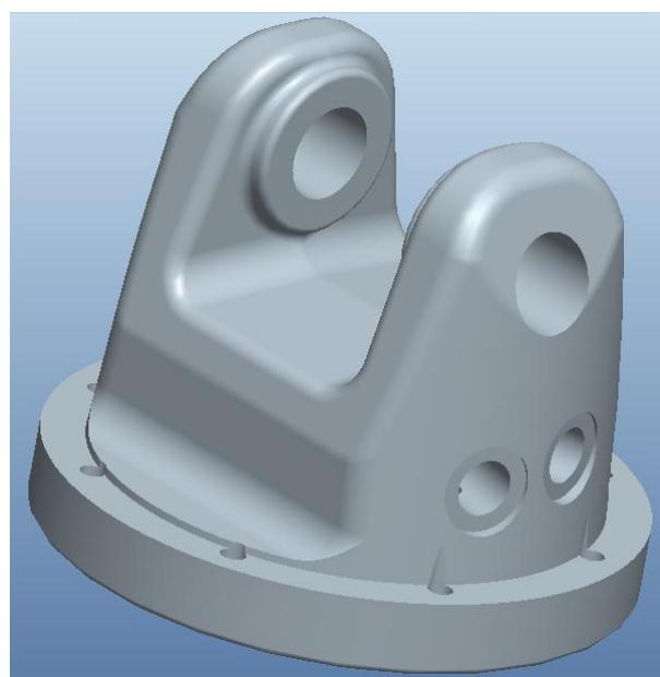
Slika 20. Kućište hidromotora
