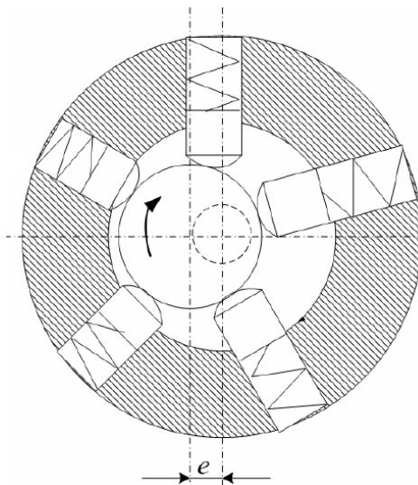
Slika 17. Radijalno klipni motor s ekscentričnom osovinom
