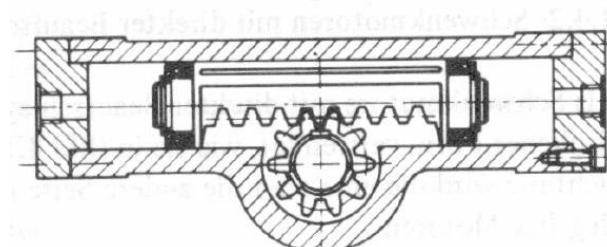
Slika 4. Presjek zakretnog motora s nazubljenim klipom
