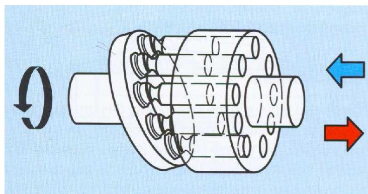
Slika 13. Aksijalno klipni motor sa zaokrenutom pločom
