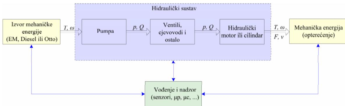
Slika 1. Prikaz toka energije kroz hidraulički sustav
