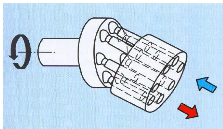
Slika 14. Aksijalno klipni motor sa zaokrenutim bubenjem
