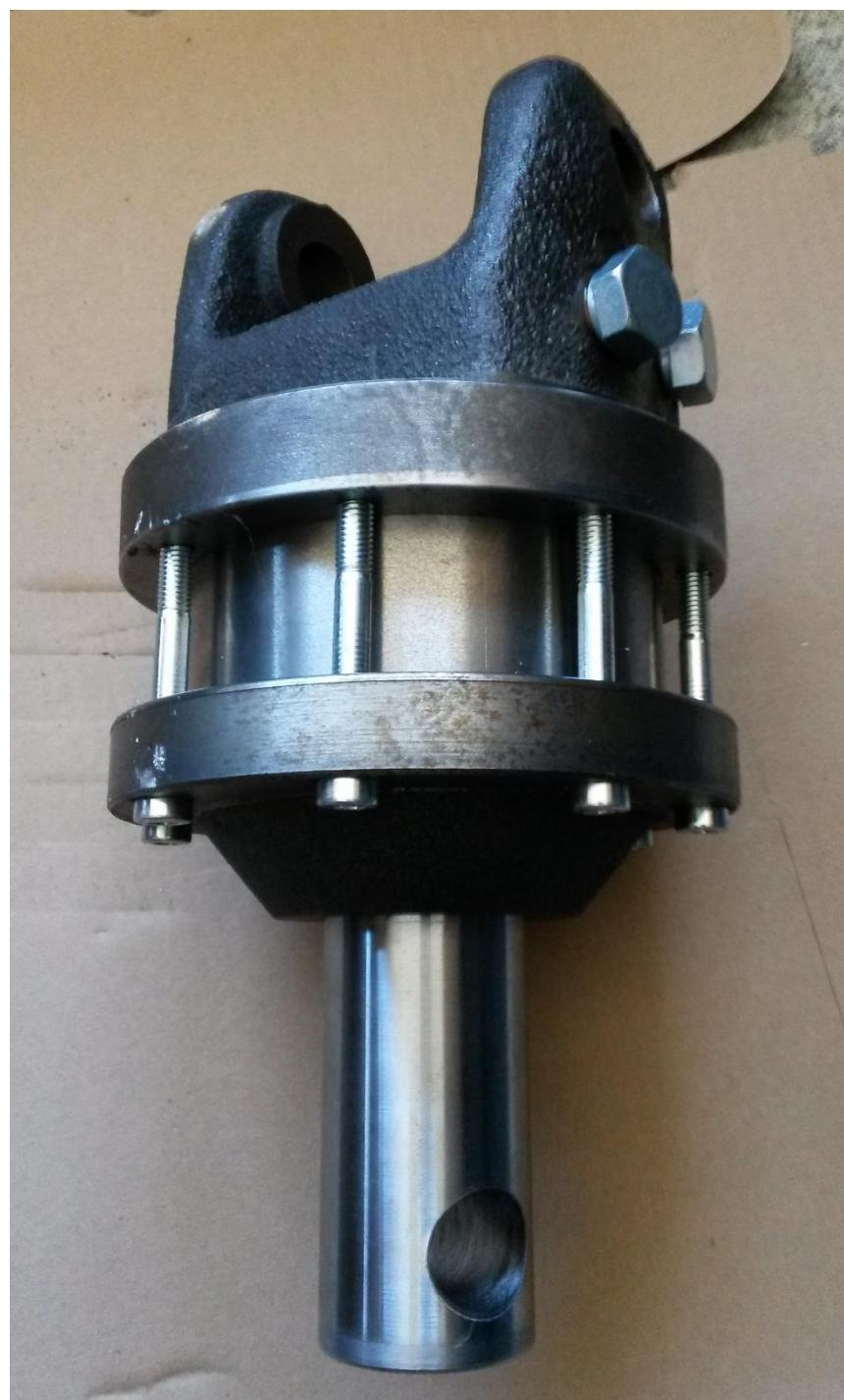
Slika 28. Stvarni izgled hidrauličkog motora
