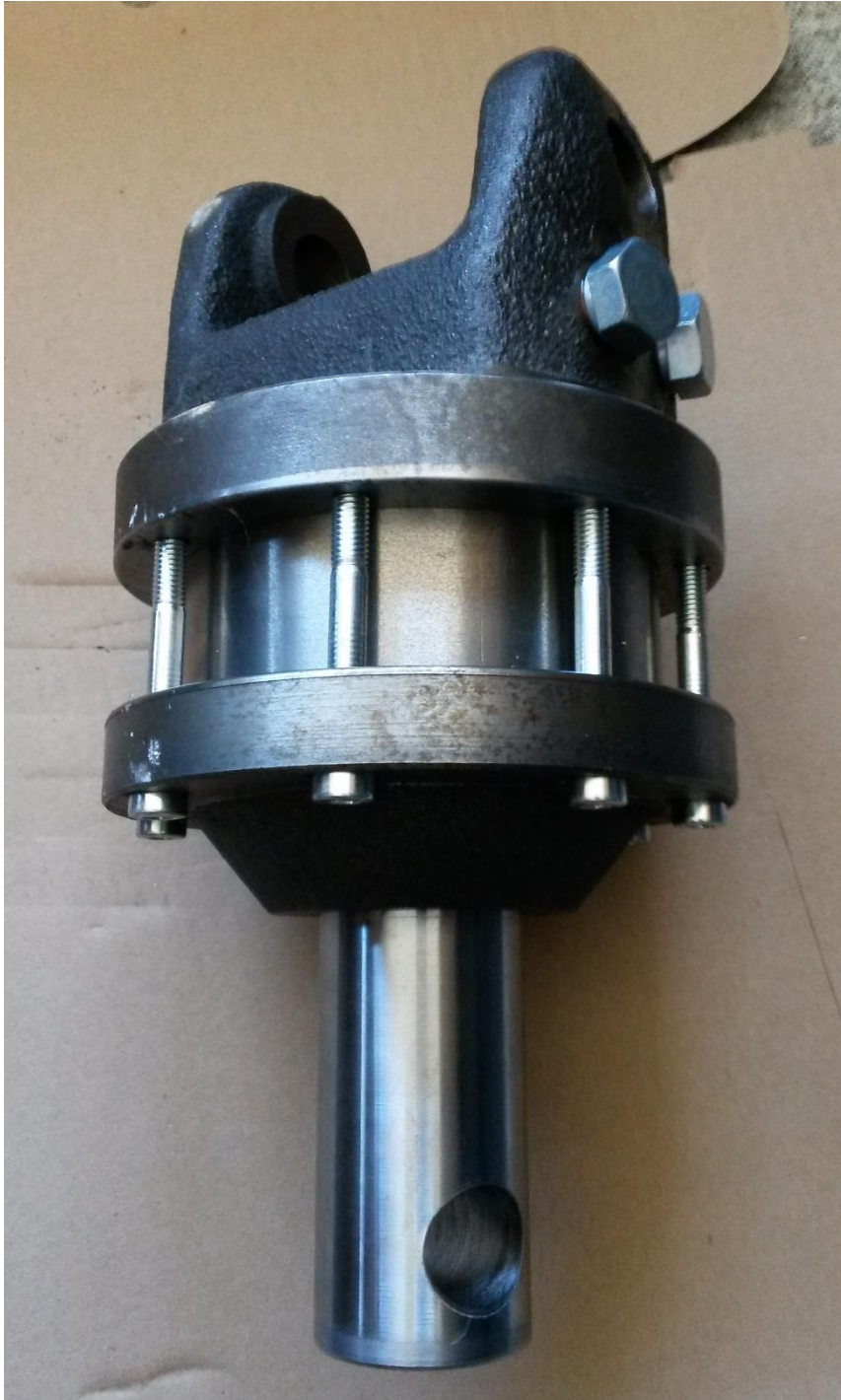
Slika 28. Stvarni izgled hidrauličkog motora
