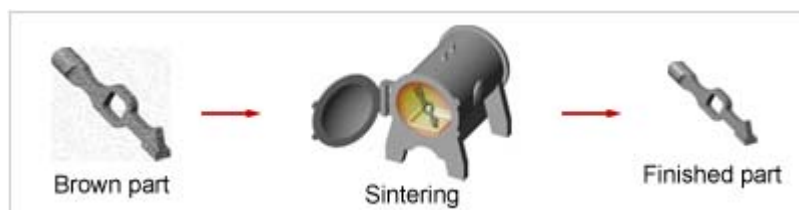
Slika 50. Prikaz procesa sinteriranja [39]
