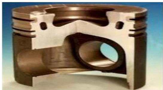
Slika 40. Klip od kompozita Al-legure [19]
