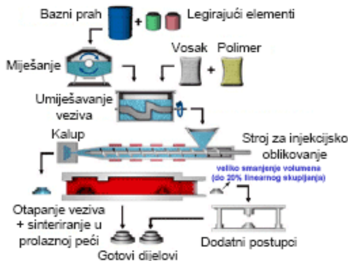
Slika 46. MIM postupak – injekcijsko prešanje metala [34]
