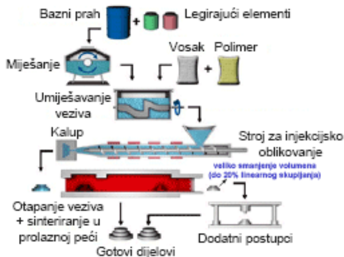
Slika 46. MIM postupak – injekcijsko prešanje metala [34]
