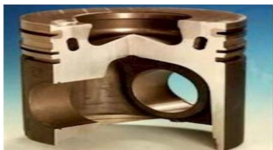
Slika 40. Klip od kompozita Al-legure [19]
