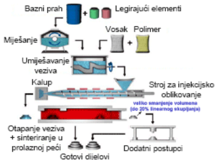
Slika 46. MIM postupak – injekcijsko prešanje metala [34]
