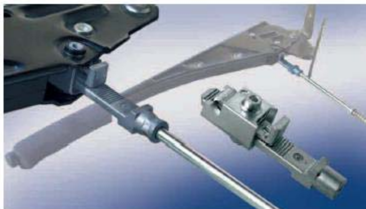
Slika 53: Rebalans ručna kočnica [36]
