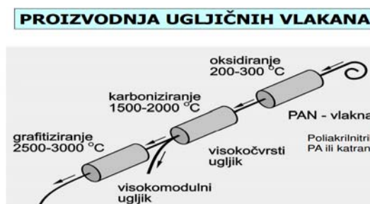
Slika 21: Prikaz postupka produvdnje vlakana – ugljičnih [9]
