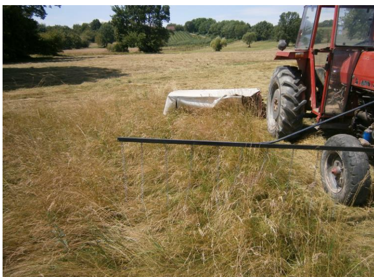
Slika 18. Postavljena plašilica od lanaca ispred rotacijske kosilice (vlastita konstrukcija)
