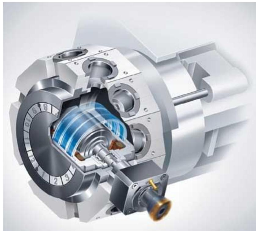
**Slika 19** Prikaz pogona reznog alata na revolverskoj glavi [7]
