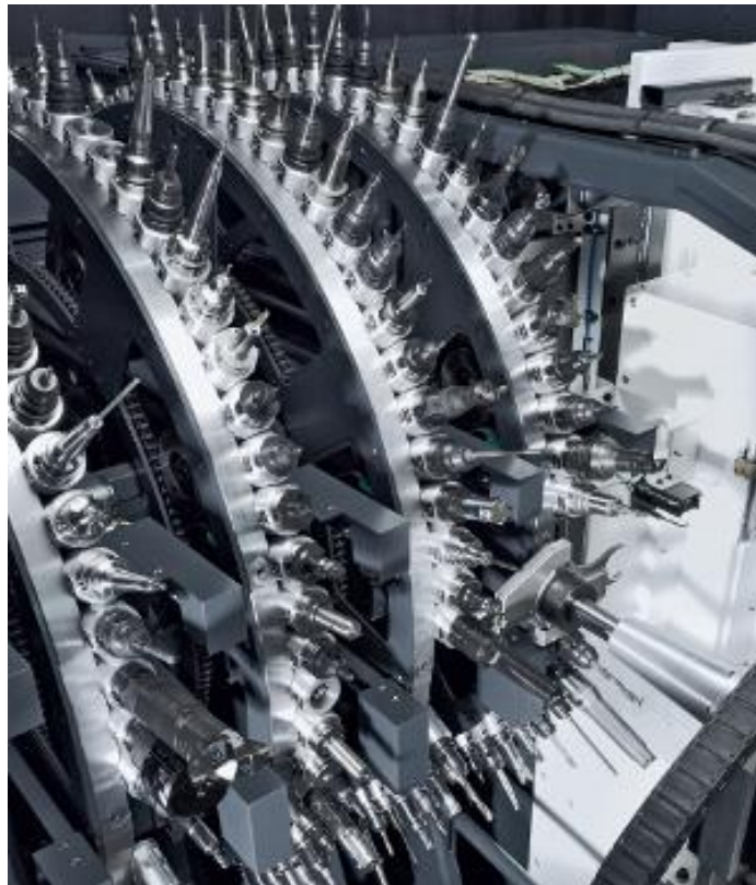
Slika 41 Diskovno spremište alata [7]
