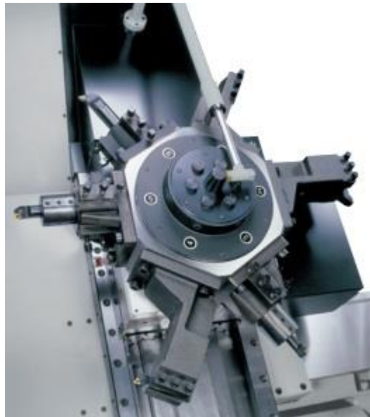
Slika 14 Revolverska glava sa okomitom osi rotacije [7]
