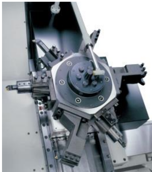
Slika 14 Revolverska glava sa okomitom osi rotacije [7]
