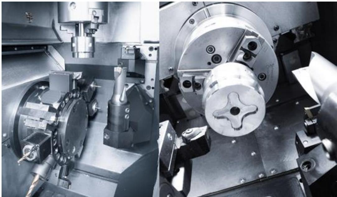
**Slika 8** Izvedba proizvodnog vertikalnog tokarskog obradnog centra [7]
