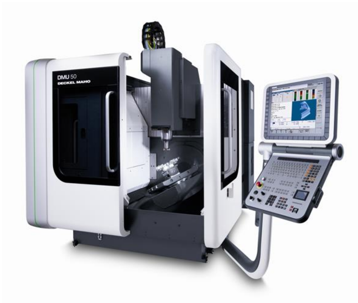
Slika 33 Petroosni glodači obradni centar DMG MORI 50 [15]
