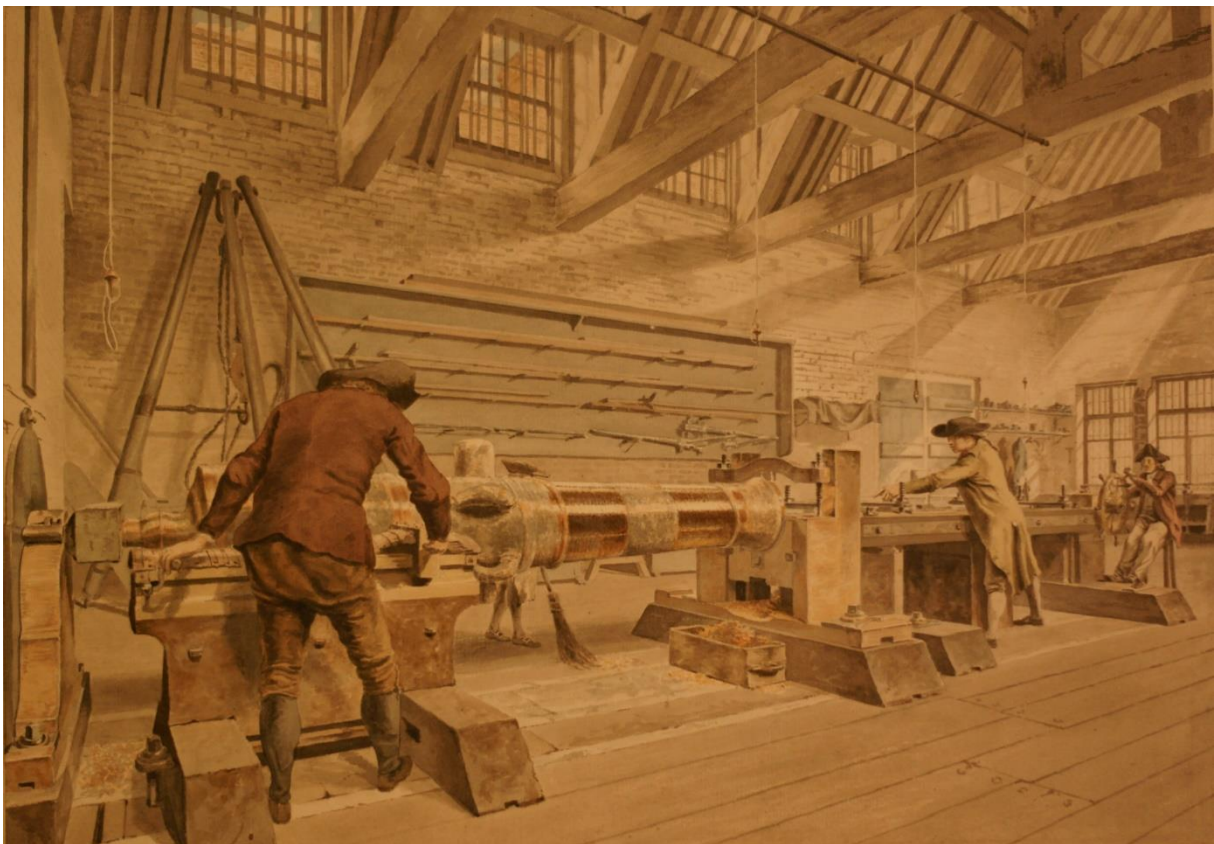
Slika 2 Horizontalna bušilica u Woolwich-u [4]
