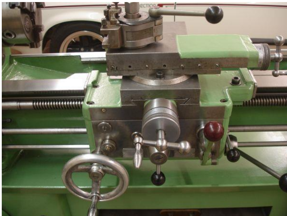
Slika 11 Prihvat alata (suport) na konvencionalnoj tokarilici [8]
