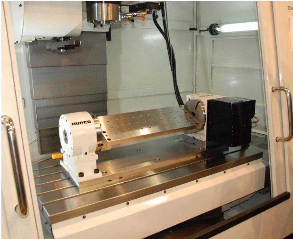
**Slika 66** Modularni okretni stol na troosnom vertikalnom glodačem obradnom centru [24]
