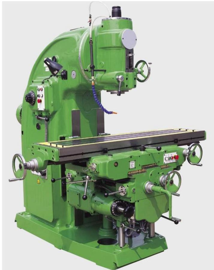
**Slika 26 Konvencionalna (klasična) glodalica**
