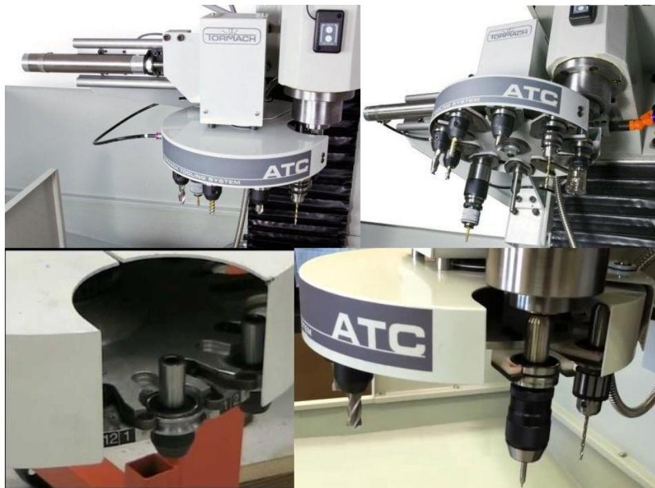
**Slika 43** AIA na kružnom spremištu alata, TORMACH [17]
