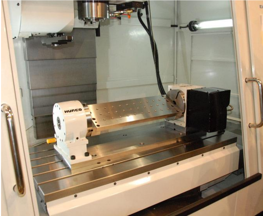
Slika 66 Modularni okretni stol na troosnom vertikalnom glodaćem obradnom centru [24]
