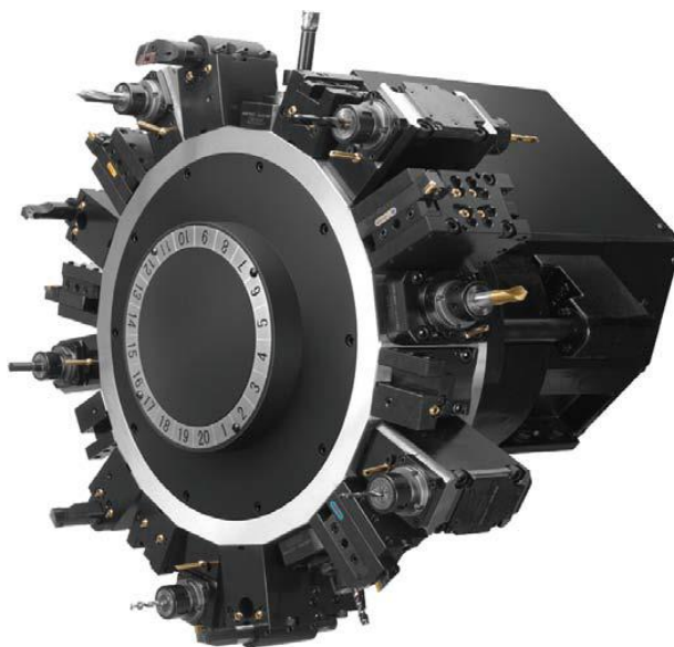
Slika 16 Revolverska glava sa 20 alata [7]
