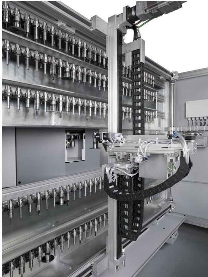
Slika 40 Regalno spremište alata [19]
