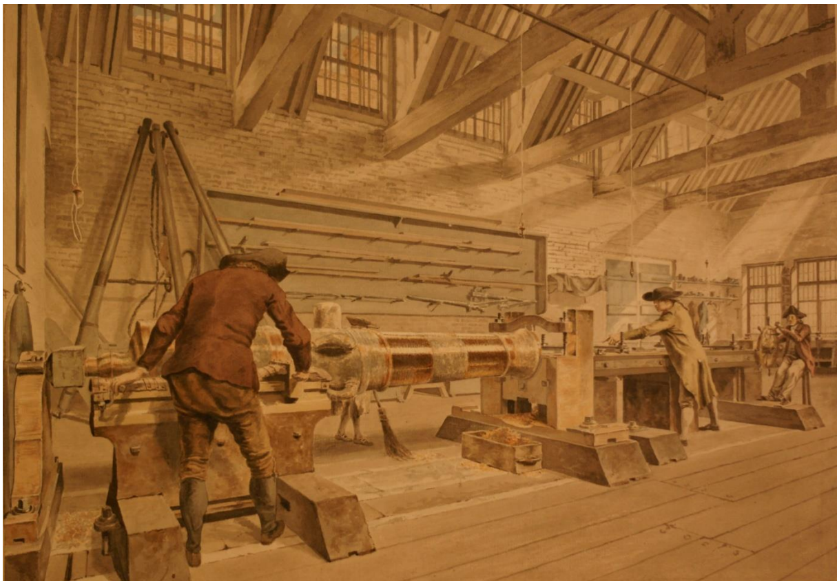
Slika 2 Horizontalna bušilica u Woolwich-u [4]
