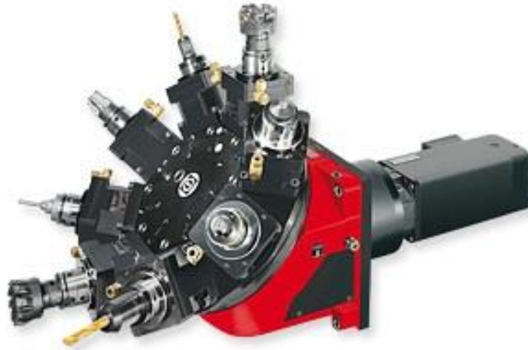
Slika 15 Revolverska glava sa koso postavljenom osi rotacije [9]
