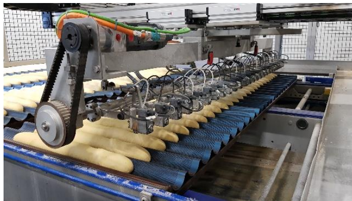
Slika 7. Vodeno narezivanje / Autor slike 7: Antun Omrčen
