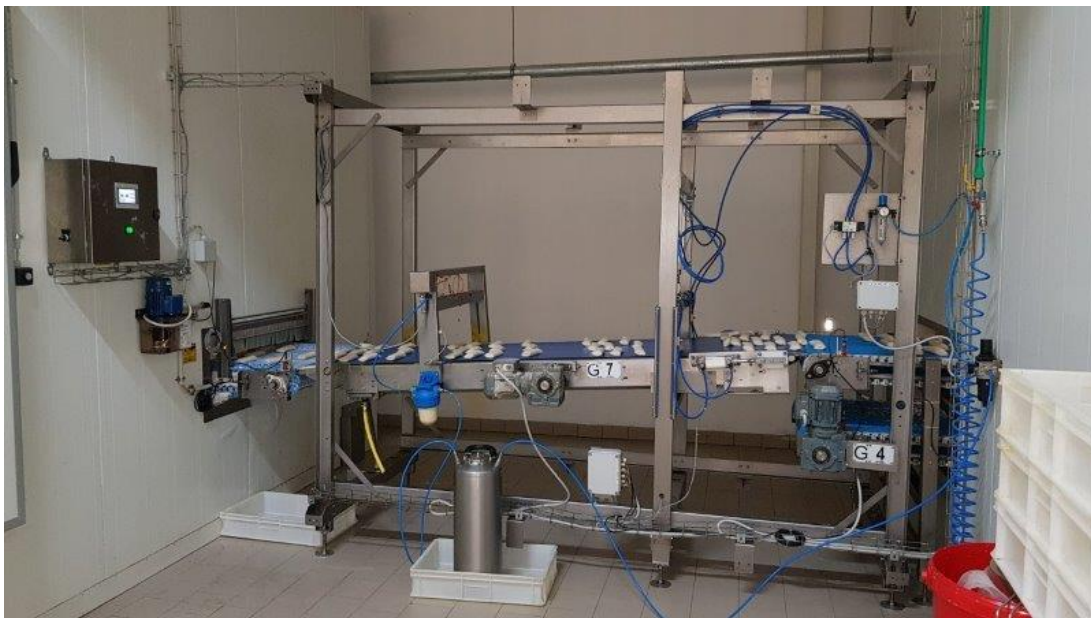
Slika 21. Slika raspršivača ugrađenog na liniji / Autor slike 21: Antun Omrčen
