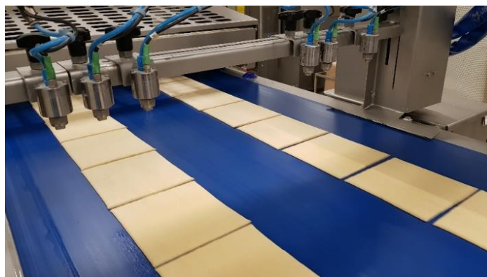
Slika 3. Raspršivanje vode / Autor slike 3: Antun Omrčen
